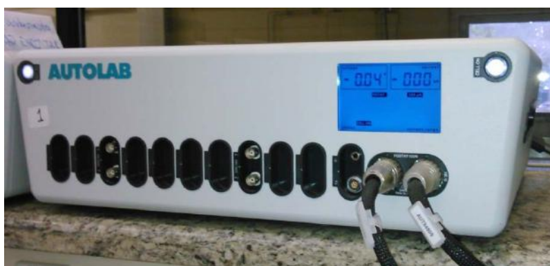
Figura 25: Potenciostato utilizado no ensaio de permeação eletroquímica e na polarização potenciodinâmica.
