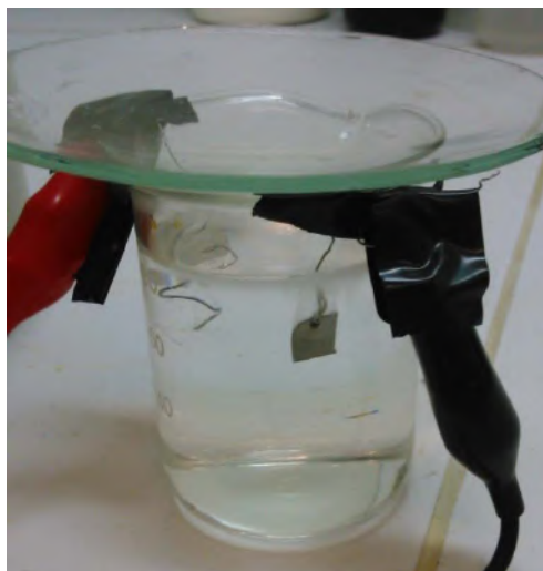
Figura 30: Hidrogenação de amostra para ensaio de TDS com solução NaCl 3,5%.
