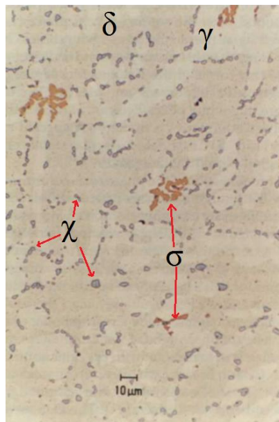
Figura 33: Microestrutura após ataque. Fase sigma ( \sigma ) em marrom; fase chi ( \chi ) em azul; ferrita ( \delta ) em marrom claro; fase austenita ( \gamma ) em branco. Adaptado de [42].
