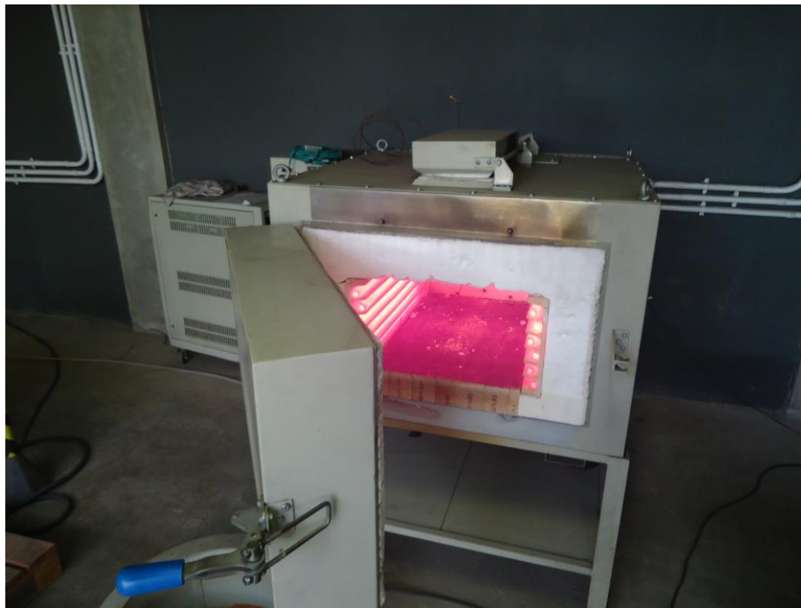
Figura 21: Forno utilizado para o tratamento térmico dos corpos-de-prova.
