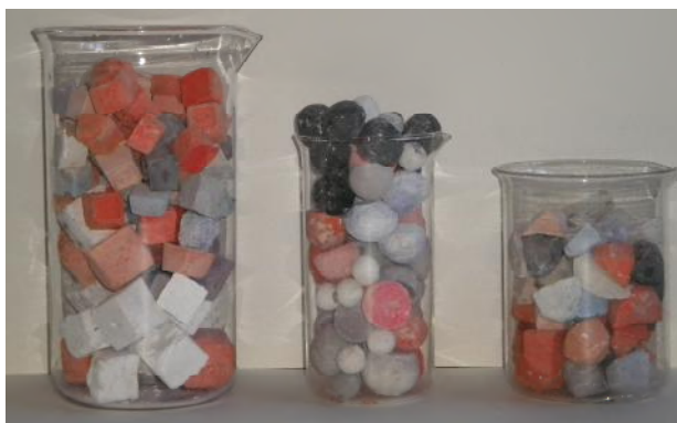
Figura 6.5 - Pelotas produzidas para simulação de minério no mineroduto.
