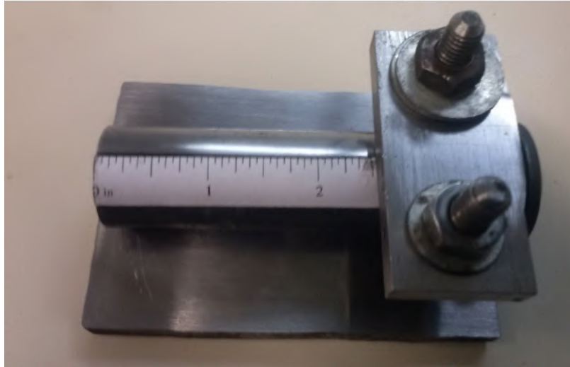
Figura 3.8– Dispositivo para posicionamento das amostras Jominy para os ensaios de dureza, com a escala de posicionamento do indentador.
