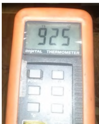
Figura 3.3 – Leitura digital da temperatura pelo termopar de certificação
