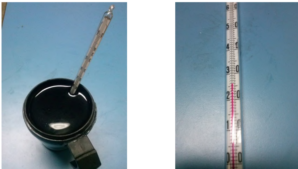
Figura 3.6 – Aferição da temperatura da água utilizada na têmpera das amostras.
