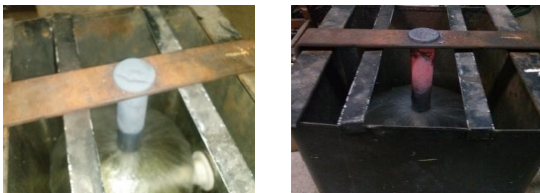
Figura 3.7– Amostra Jominy em processo de têmpera
