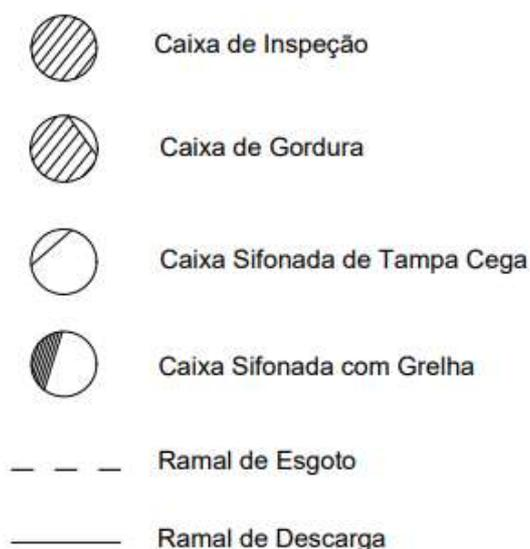
**Figura 18: Simbologia utilizada para dimensionamento das instalações prediais. Fonte: NBR 8160 (ABNT, 1999)**
