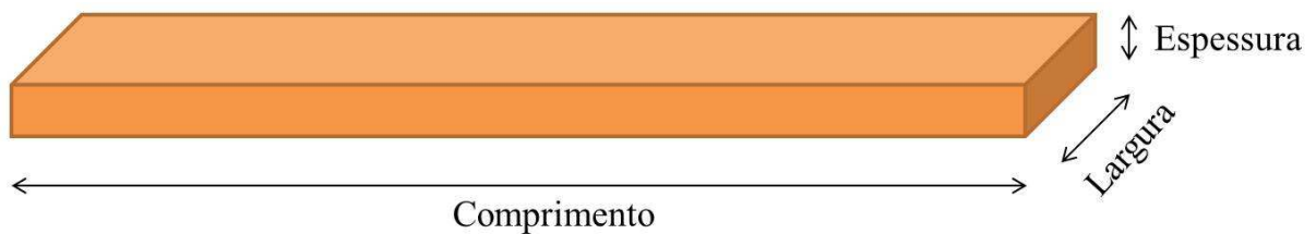
Figura 3: Representação das dimensões do corpo de prova utilizado no ensaio de expansão térmica.
