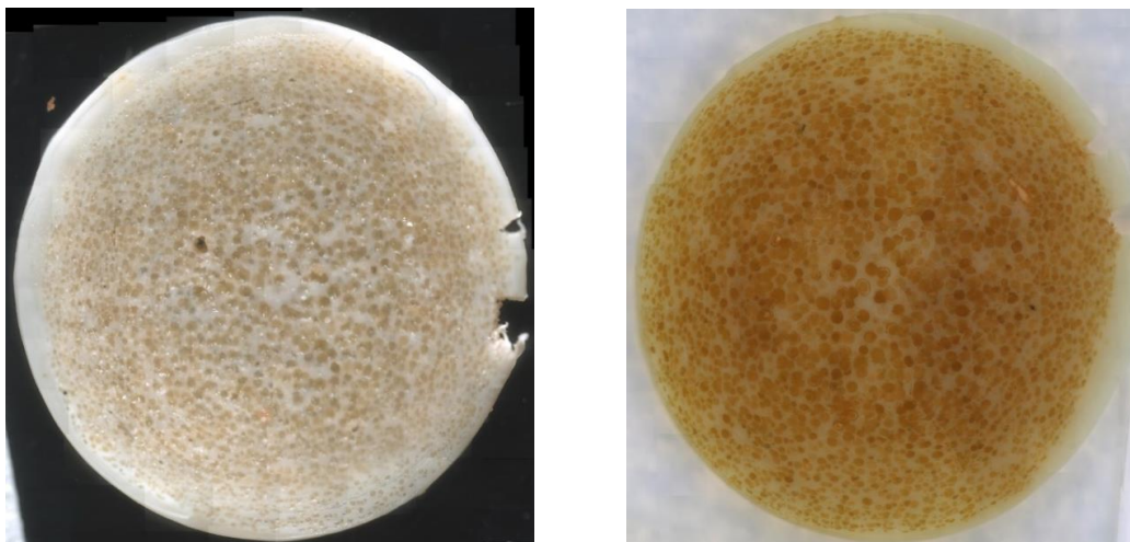
Figura 21: Imagens obtidas através da análise microscópica da biomedia Mutag Biochip™, mostrando o crescimento do biofilme após um período de 1 mês.
