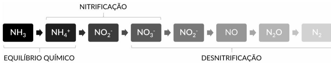
Figura 2: Transformação do nitrogênio ao longo dos processos de nitrificação (oxidação) e desnitrificação (redução) (Elaboração própria).
