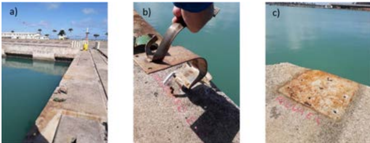
Figura 7 –Estação Maregráfica EST_EIC: a) Região de implantação da Estação; b) Estruturas de fixação do mareógrafo; e c) Local de fixação da régua maregráfica. Elaborado pelos autores.
