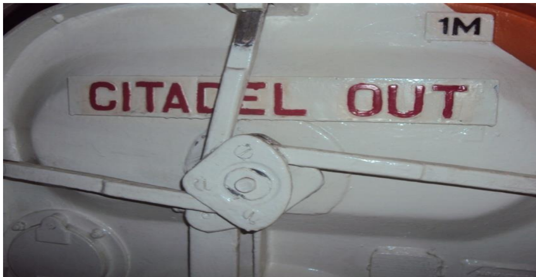
Figura 3: Porta estanque sinalizando limite de cidadela 1M. Disponibilizado por CF-REBELO, Instrutor e Ex-Comandante do GRUCAV.
