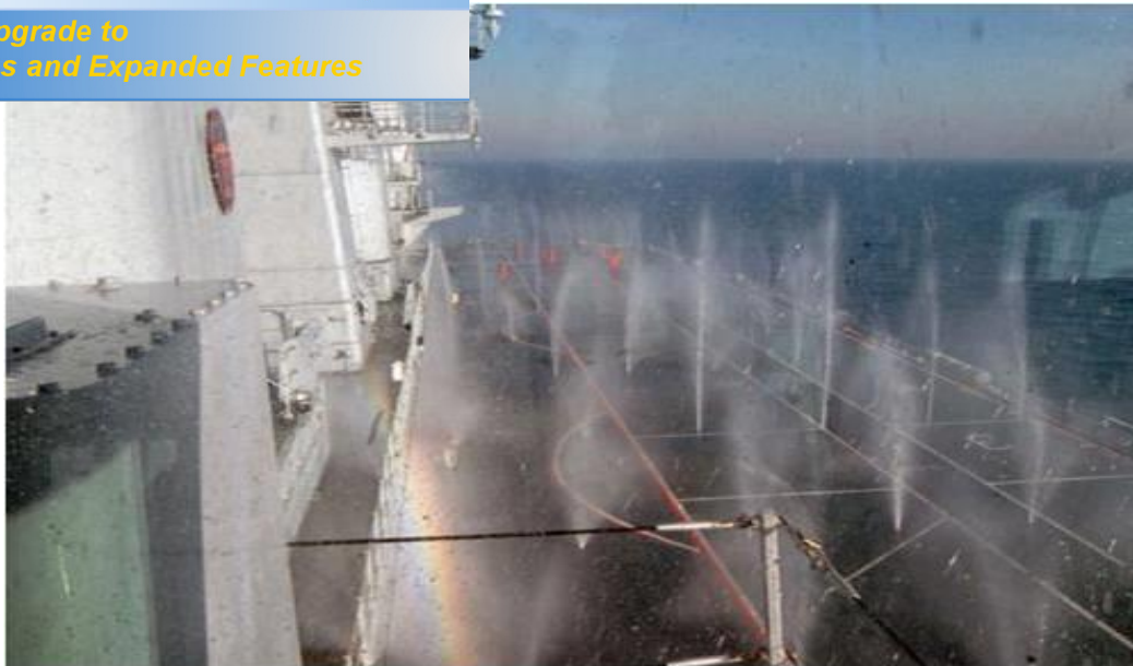
Figura 4: Sistema Prewetting . Disponibilizado por CF- REBELO. Instrutor e EX-Comandante do GRUCAV.
