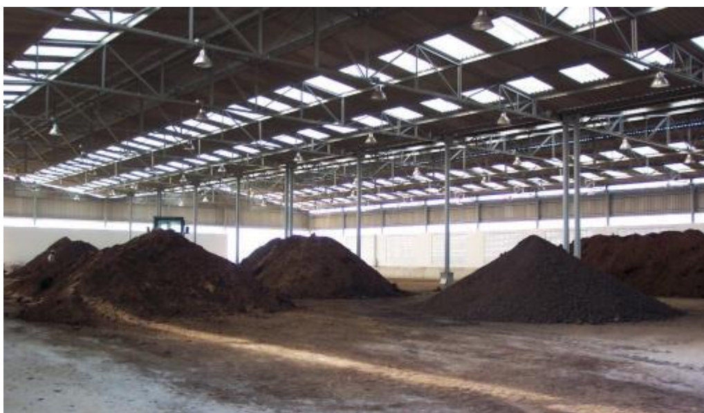
Figura 10 - Uso de Biopilhas para o tratamento de solo contaminado. Fonte: Seabra, 2015
