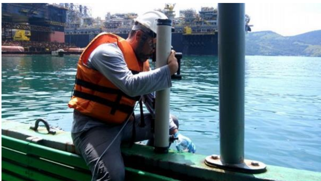
Figura 9 – Retirada das amostras de água de fundo com auxílio da garrafa Van Dorn.
