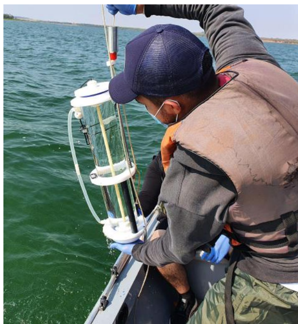
FIGURA 3.5 – AMOSTRAGEM COM GARRAFA DE VAN DORN
