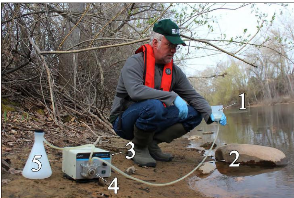
FIGURA 3.1 – CONJUNTO DE EQUIPAMENTOS PARA FILTRAÇÃO DE AMOSTRAS EM CAMPO 1)Funil de filtração; 2)Mangueira de silicone; 3)Motor para bomba peristáltica; 4)Cabeçote para bomba peristáltica; 5)Frasco para coleta de filtrado
