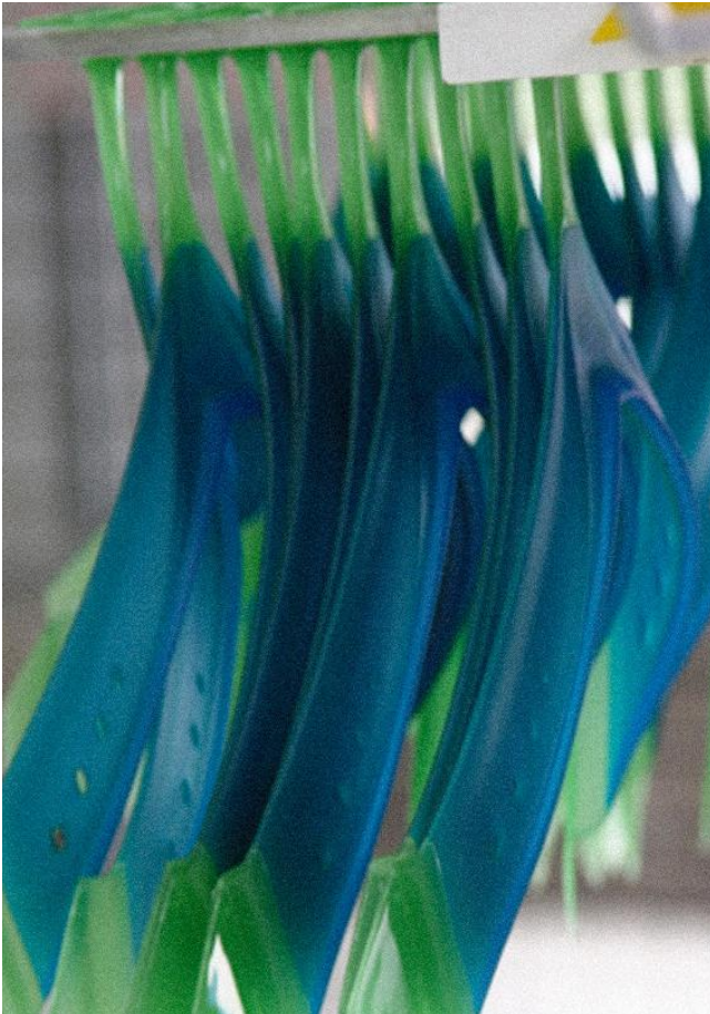
Figura 8. Cabedais injetados saindo em galho da injetora bicolor Fonte:Acervo S2 HOLDING
