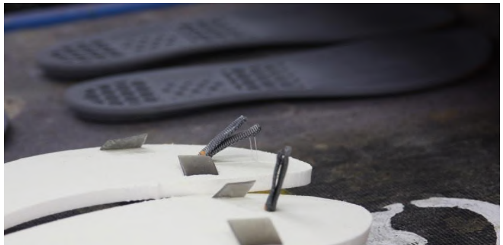
Figura 9. Cabedais trançados sendo colados em palmilhas Fonte:Acervo S2 HOLDING
