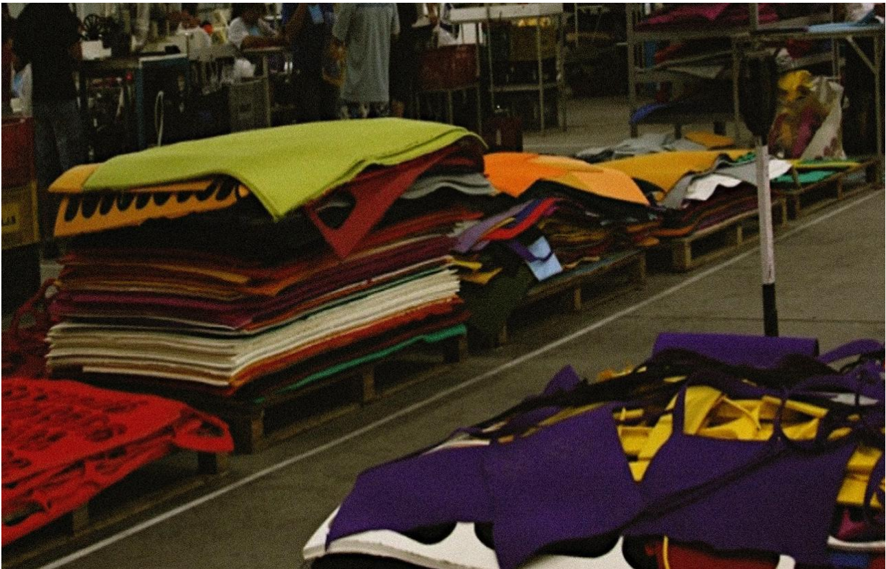
Figura 13. Placas e descartes de palmilha de EVA no chão de fábrica. Fonte:Acervo S2 HOLDING
