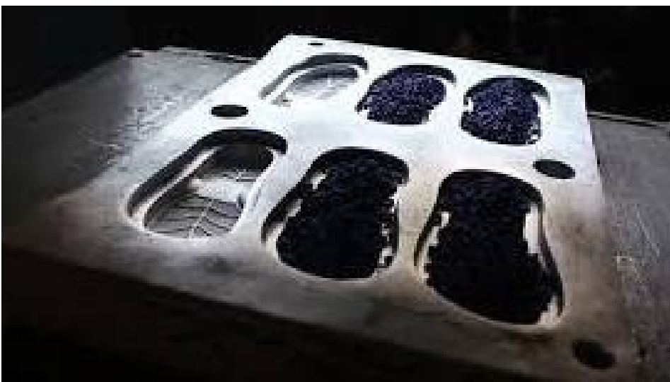
Figura 22. Derrame de EVA em Palletes sob molde para expansão. Fonte: http://www.jjplast.com.br/
