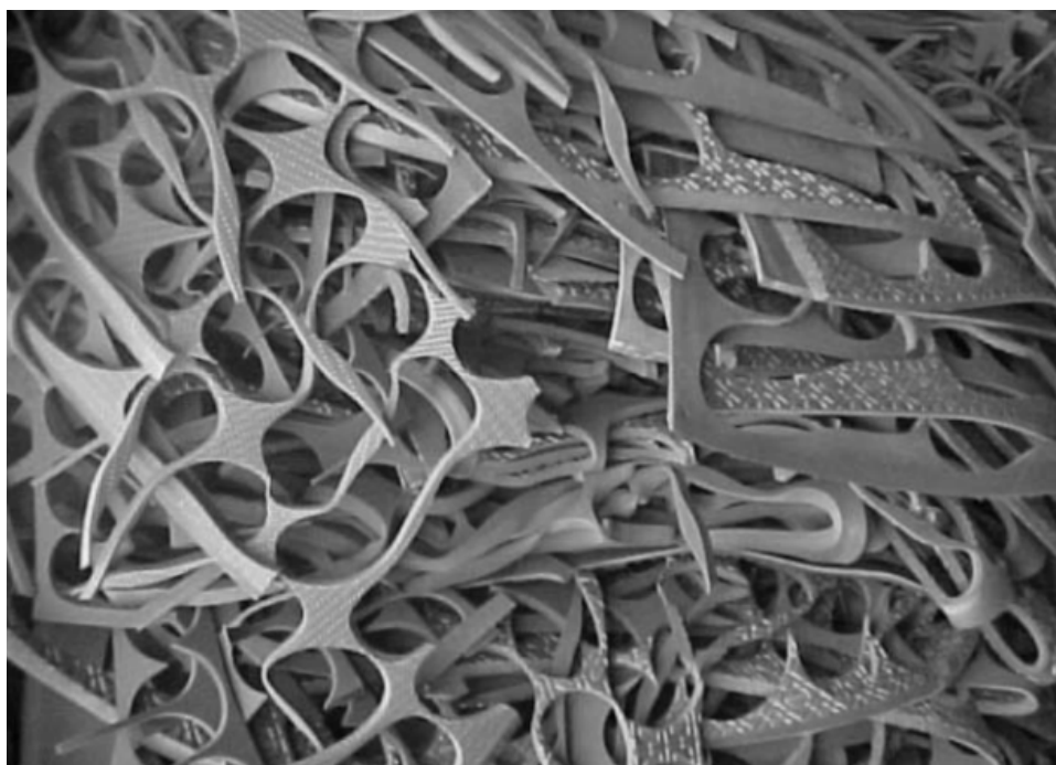
Figura 14. Placas e descartes de palmilha de EVA no chão de fábrica. Fonte: Acervo S2 HOLDING
