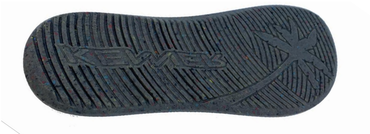
Figura 20. Solado de material reciclado a partir da moagem de uma sandália inteira. Fonte:Acervo S2 HOLDING
