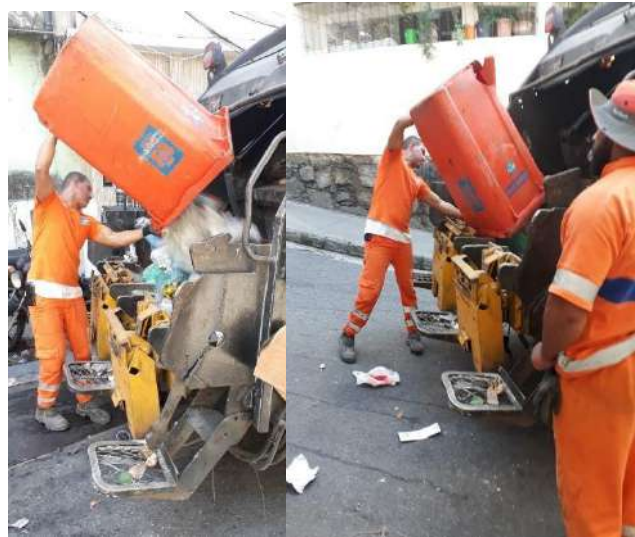
Figura 43 - Gari suspendendo o contêiner e jogando os resíduos no compactador do caminhão
