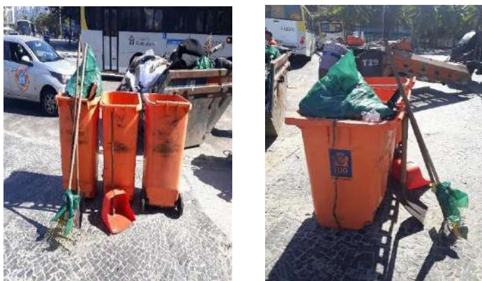
Figura 14 - Imagens dos contentores sem espaço para o ferramental do gari (rastelo, papão e pá)
