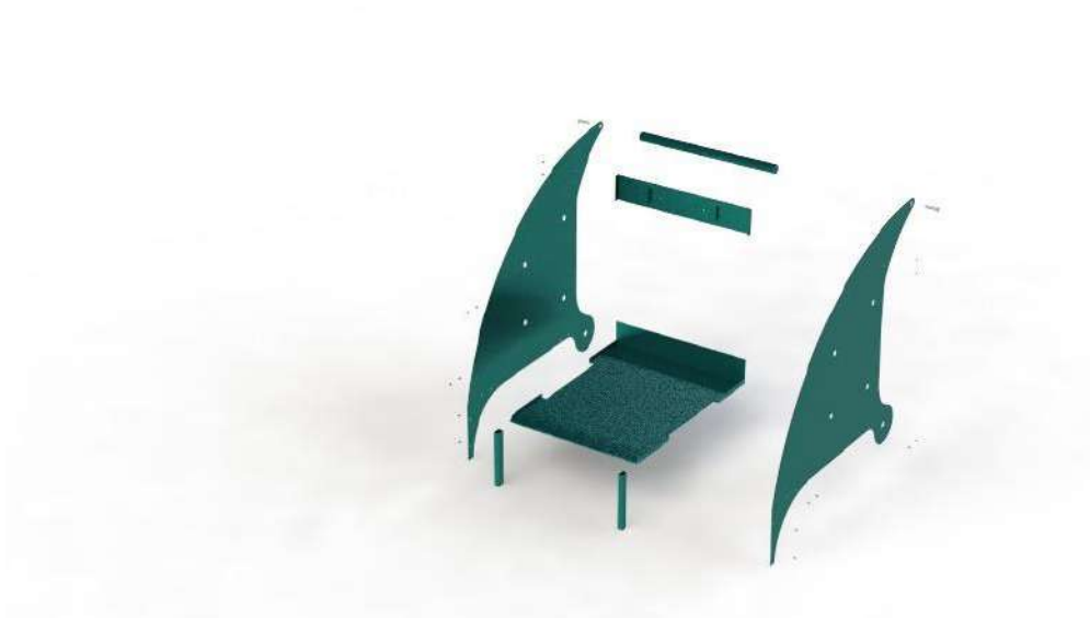
Figura 81 - Subsistema: Estrutura de suporte
