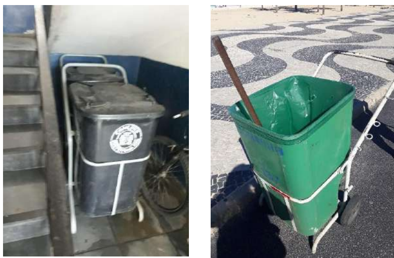
Figura 2 - Lutocar sem espaço para ferramentas e modelo utilizado como recipiente térmico
