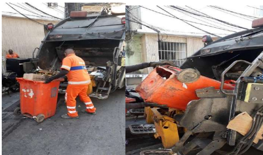
Figura 27 - Imagem de um gari colocando o contêiner quebrado no elevador do caminhão
