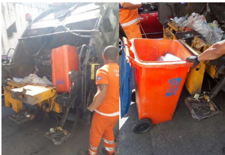
Figura 15 – O elevador, que levanta o contêiner, quebrado e o mesmo caindo dentro do caminhão
