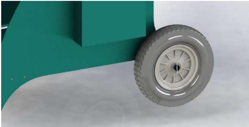
Figura 64 - Sistema de movimentação: roda, arruela e cupilha
