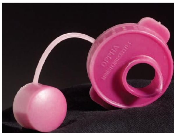
Figura 38: Descoloração desigual em uma tampa de leite dinamarquesa da década de 1960 devido à exposição prolongada à luz do sol.
