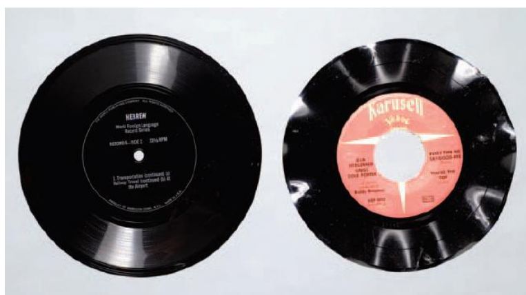
Figura 40: Disco de vinil (PVC) antes (esquerda) e depois (direita) de degradação sofrida após aquecimento à 50°C por 30 minutos.
