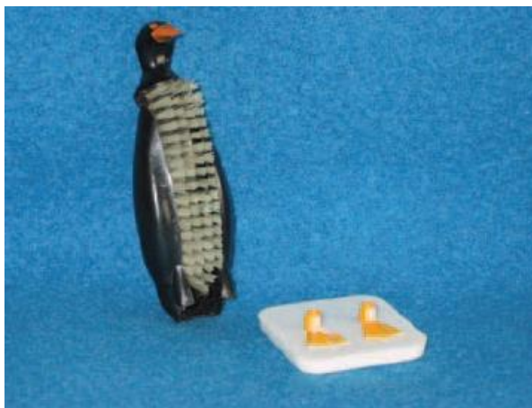
Figura 42: Escova de unha de poliestireno separada de sua base pelo dano mecânico consequente de uma queda.
