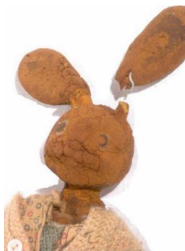
Figura 41: Oxidação na borracha natural, causando desintegração da estrutura polimérica. Fonte: KENEGHAN, Brenda. Plastics in collections – V&A Museum, 2007
