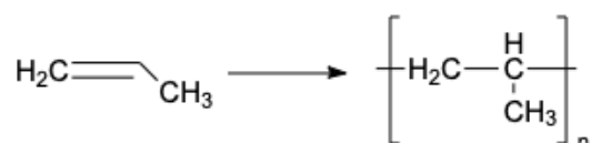
Figura 14: Polimerização por adição do polipropileno Fonte: Imagem da autora
