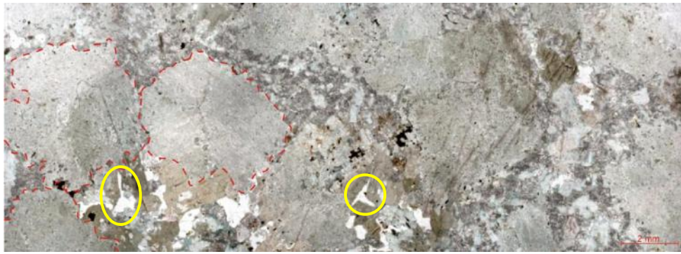
Figura 29 - Microfotografia de gabro Vitoriano Veloso, fácies grossa, contendo grãos pseudomorfos de piroxênio (pontilhado vermelho) e quartzo (elipse amarela) com formas xenomórficas típicas de cristalização tardia, preenchendo espaços restantes. Polarizadores paralelos. Lâmina JU-68A.
