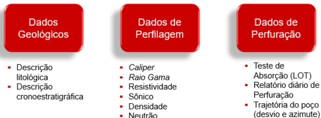
Figura 11: Dados necessários para a construção de um modelo geomecânico no software DecisionSpace Petrophysics. Os dados geológicos, de perfilagem e de perfuração foram utilizados como dados de entrada para as diversas etapas realizadas ao longo do fluxo de trabalho.
