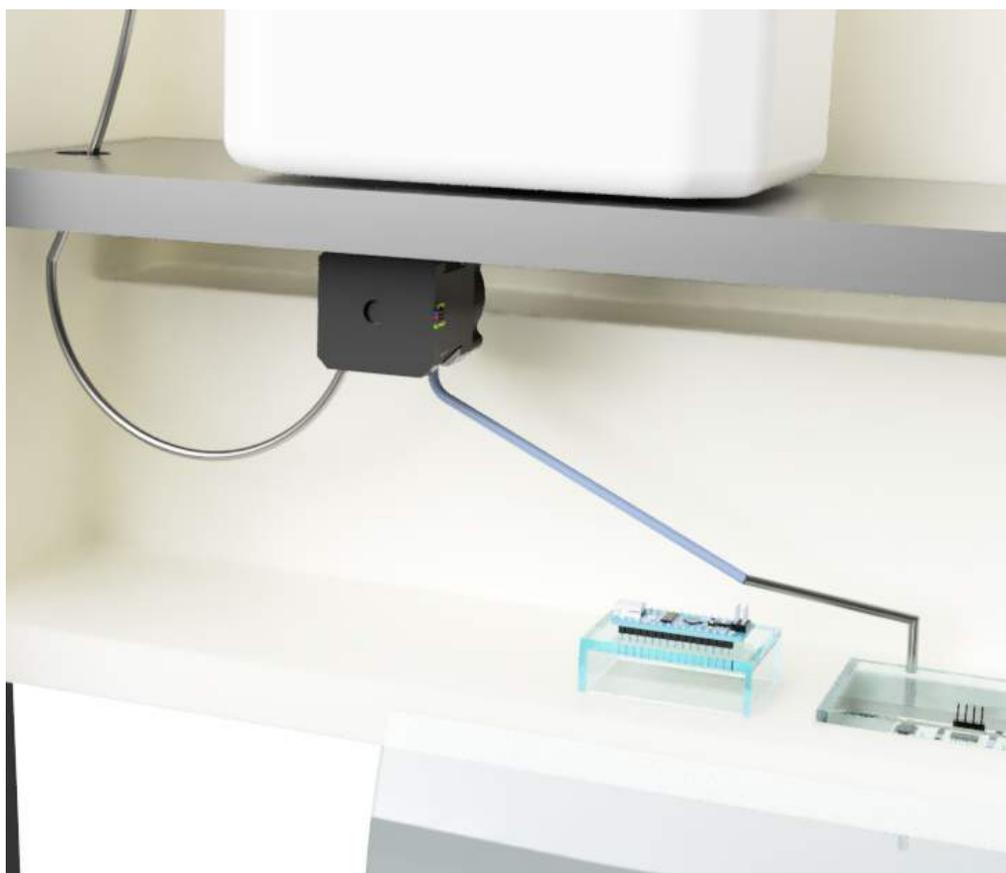
Figura 63: Detalhe das mangueiras que conectam o sistema passando pela bomba peristáltica até o tubo de saída.
