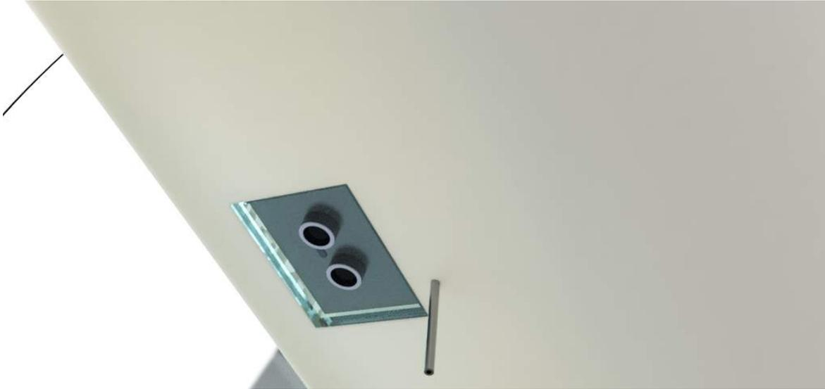
Figura 48 : o sensor ultrassônico localizado na parte inferior do totem, protegido por uma peça de acrílico. Elaboração própria.
