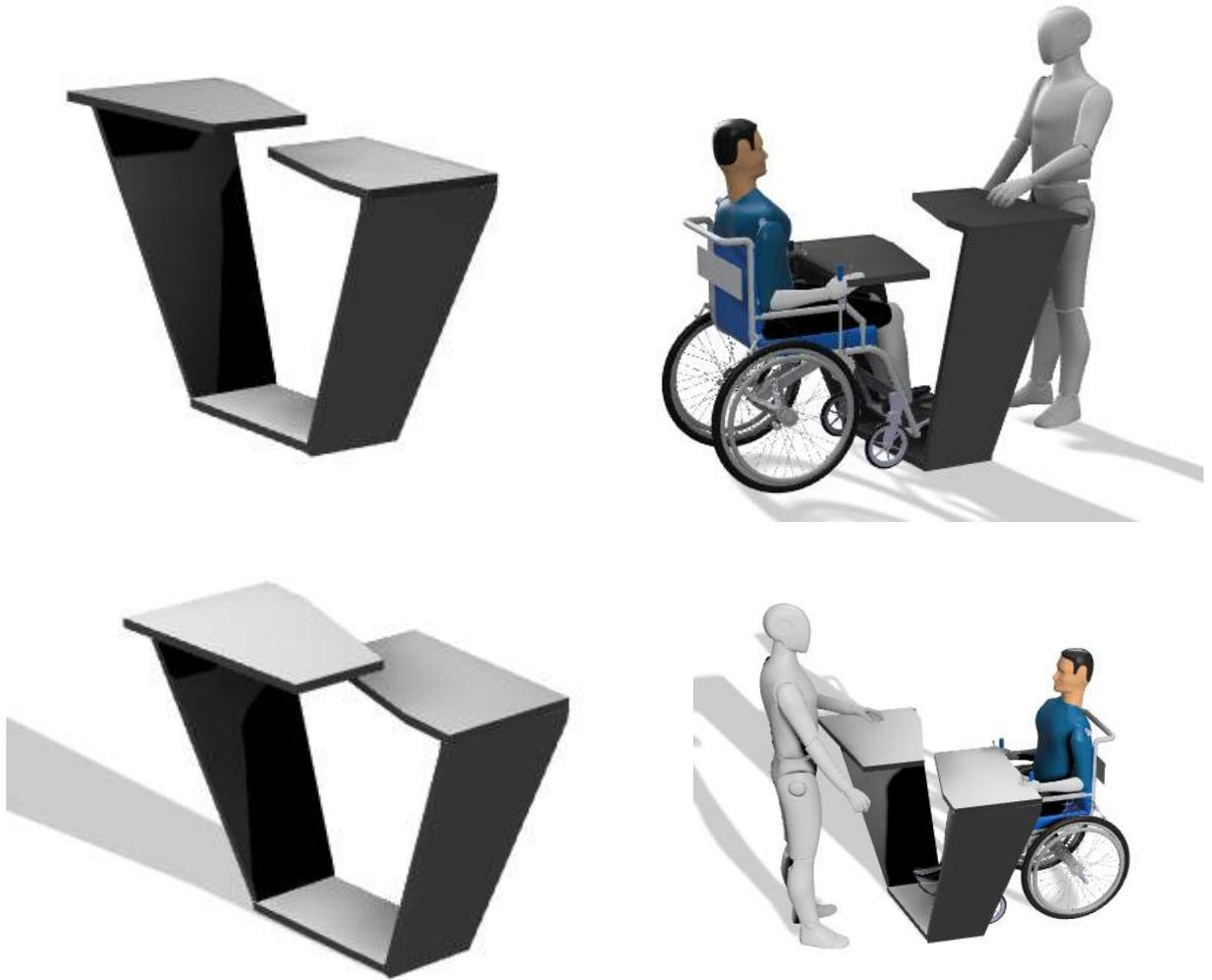
A alternativa 6 parte da ideia de uma fita única, dobrada de modo a dispor duas alturas. Formalmente é interessante, mas por conta dos ângulos acaba gerando um produto com bastante largura. Toda a leveza que o modelo volumétrico sugere também não seria aplicável quando fossem adicionados os elementos necessários para a sua concepção real.
