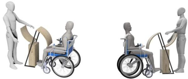
O que foi pensado para essa estrutura era uma base de apoio firme, onde estaria o refil de álcool, e uma finalização curvada para o dispositivo de saída do álcool.
