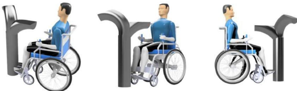
Até então não havia sido pensado em nenhum totem construído com uma base cilíndrica. A alternativa 8 procura preencher essa lacuna e é concebida como um tubo que se subdivide em outros dois tubos dispondo um intervalo de altura. É uma forma difícil de ser trabalhada, que geralmente não se harmoniza fácil com outras formas. Houve a tentativa de fazer um recorte no topo da estrutura, procurando gerar uma forma com aspecto mais original.
