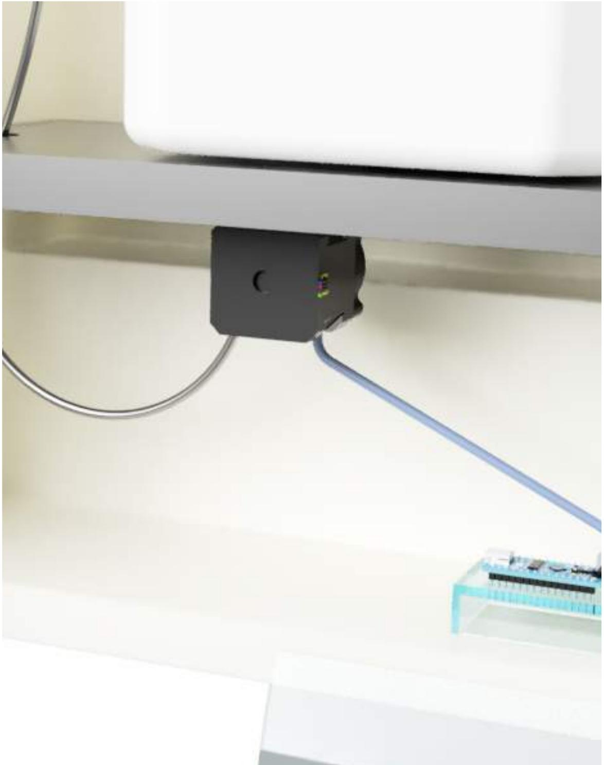
Figura 51: A bomba peristáltica presente no projeto, instalada na prateleira que separa as embalagens de álcool do circuito.
