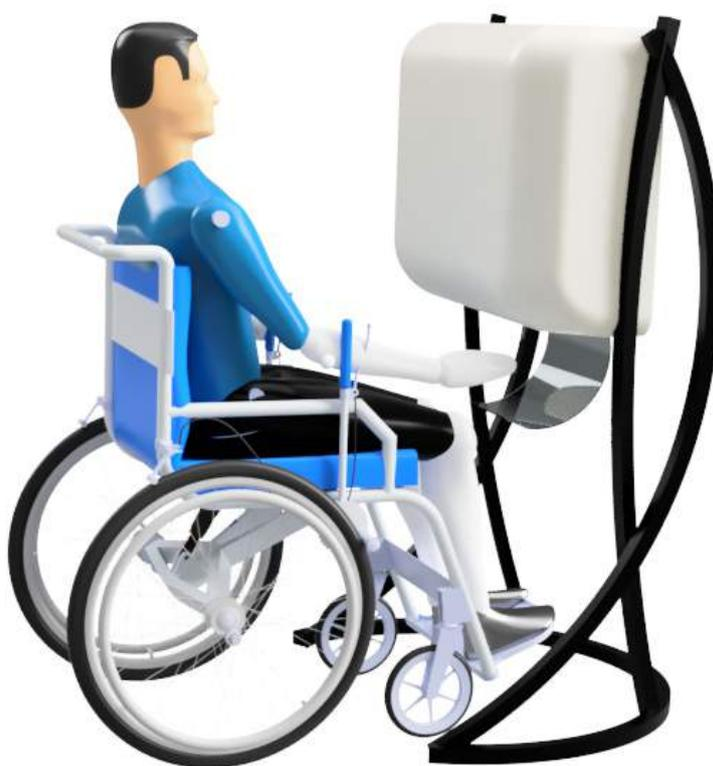
Figura 65: O Totem desenvolvido permite que cadeirantes acessem o produto de maneira frontal, adequadamente. Modelagem do Totem com elaboração própria. Modelagem de cadeirante modificada a partir de bloco 3d presente em banco de dados de uso livre (grabcad.com)
