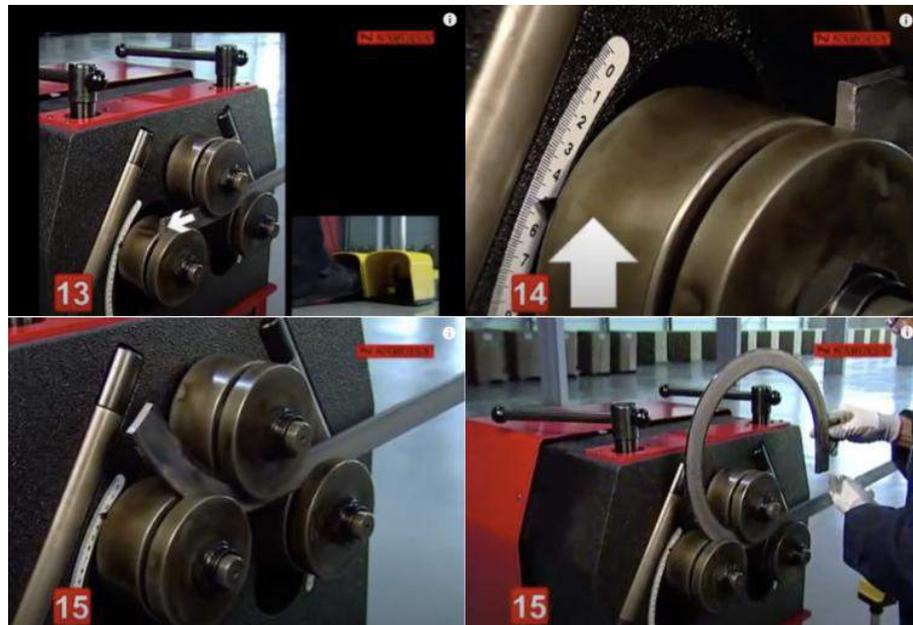
Figura 58: Um exemplo do processo de calandragem. Retirado de: <https://www.youtube.com/watch?v=067u69Q2quc>
