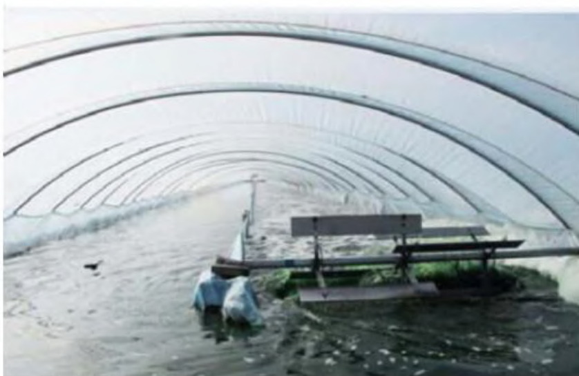
Figura 3 - SISTEMA DE LAGOS PARA A PRODUÇÃO DE MICROALGAS DO GÊNERO SPIRULINA NA MONGÓLIA INTERIOR.
