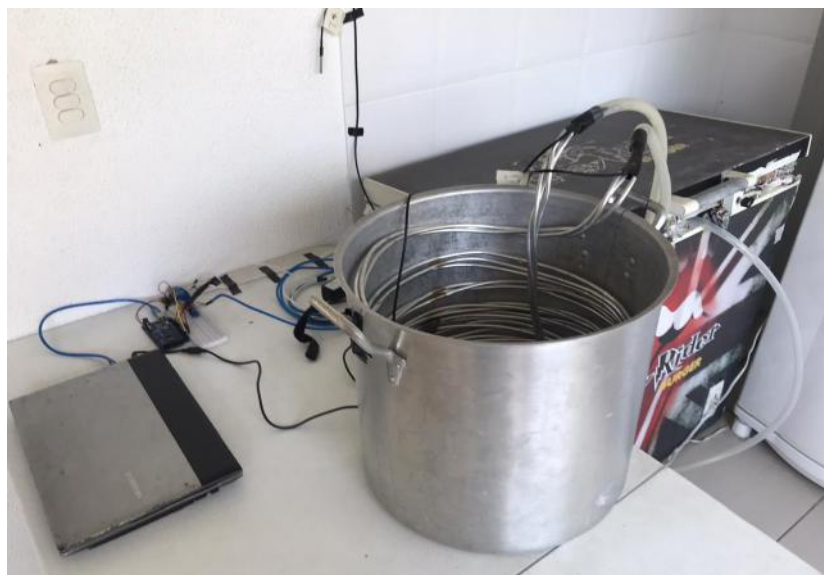
Figura 3.15 – Sistemas de Fermentação e Controle montados e conectados
