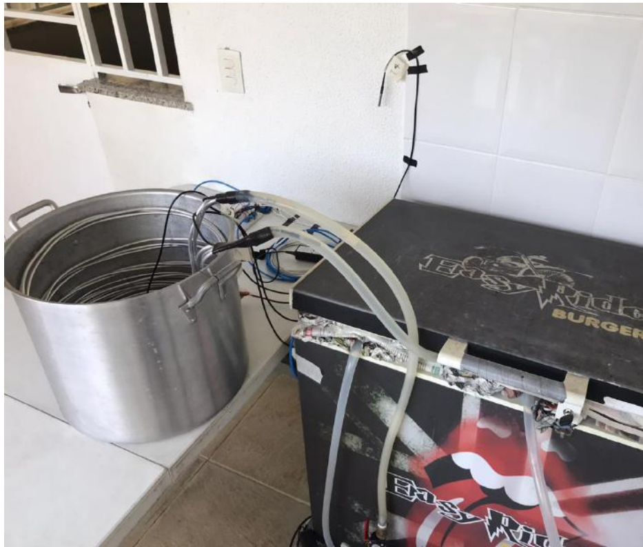
Figura 3.9 – Fermentador e freezer com tubulações
