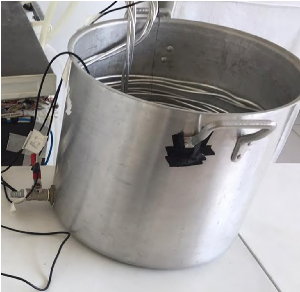
Figura 3.4 – Fermentador caseiro para a produção de cerveja
