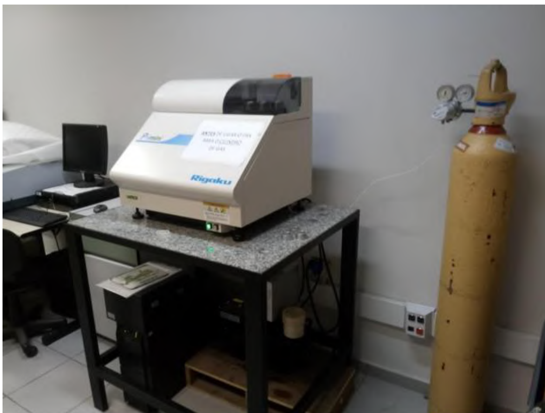
Figura 10 – Equipamento de FRX Rigaku modelo Primini utilizado na análise das amostras.
