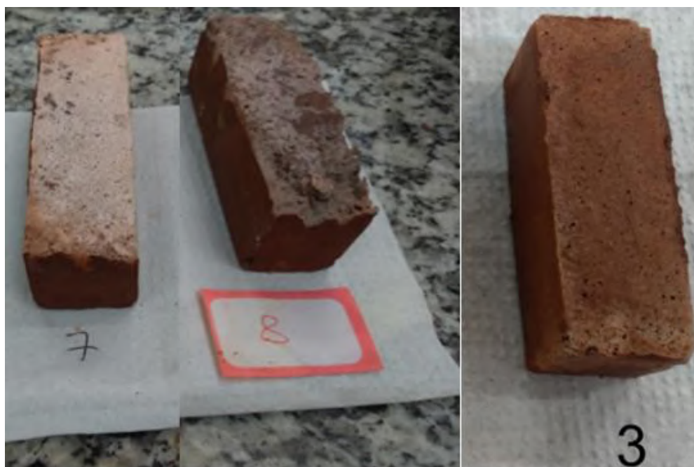
Figura 14 – Face superior dos corpos de prova 7, 8 e 3 com diferentes proporções de ECAT. O composto 3 equivale em composição ao 9.
