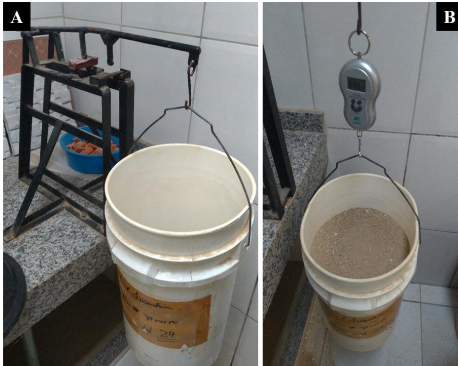
Figura 9 - Ensaio para determinar a tensão de ruptura com equipamento manual de flexão por 3 pontos. A) Adição gradual de carga até o rompimento do corpo de prova. B) Após a ruptura é realizada a pesagem da carga exercida sobre a amostra.
