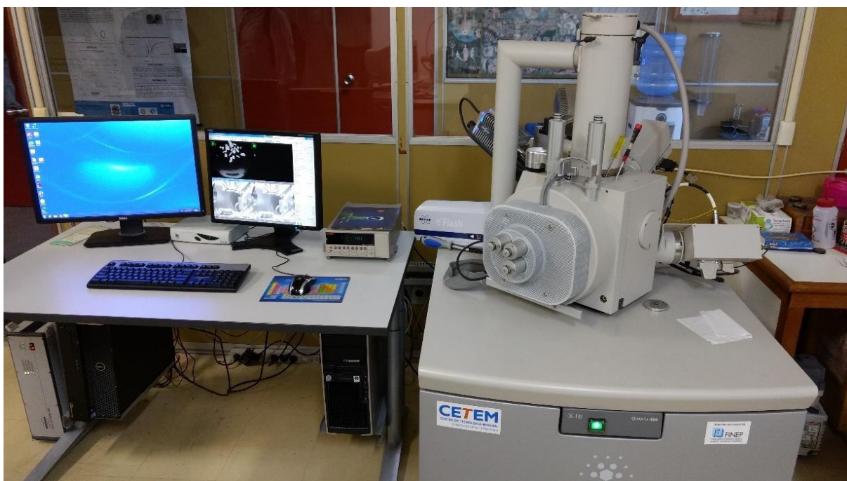
Figura 11 – Microscópio Eletrônico de Varredura FEI-Quanta 400 utilizado na análise de imagens das amostras.
