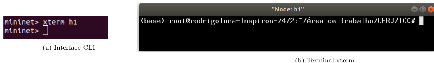
Figura 5 – Exemplo de utilização da interface CLI disponibilizada pela API da MININET. Em a) pode-se observar através da CLI da MININET a abertura de um emulador de terminal xterm para que se possa acessar ao Sistema Operacional de uma das máquinas virtuais, com o nome "h1", criada pela MININET. Em b) o terminal "xterm" da máquina virtual com o nome "h1".
