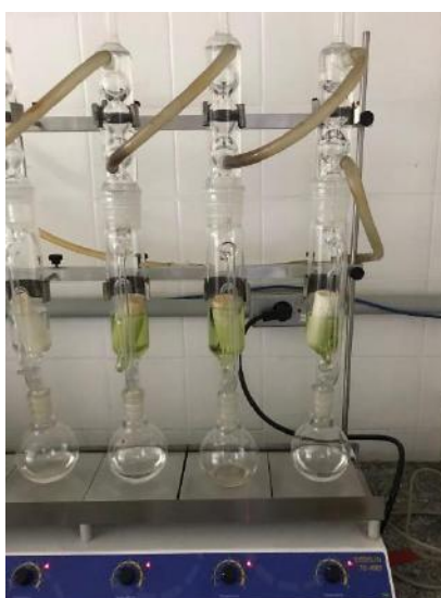
Figura 6: Aparelho de extração de lipídios neutros Soxhlet em operação com amostras de ração. Fonte: própria
