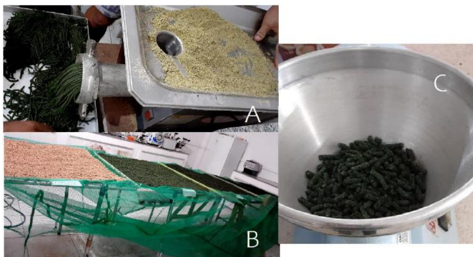
Figura 2: Processo de extrusão da ração (A), Secagem da ração a temperatura ambiente (B) e Ração final (C). Fonte: própria
