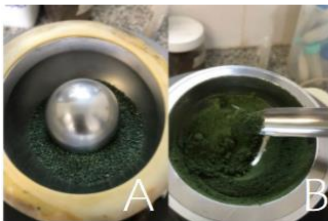
Figura 4: Ração de peixe fortificada com Spirulina maxima antes (A) e após (B) a moagem em moinho de uma bola PULVERISETTE 0 . Fonte: própria
