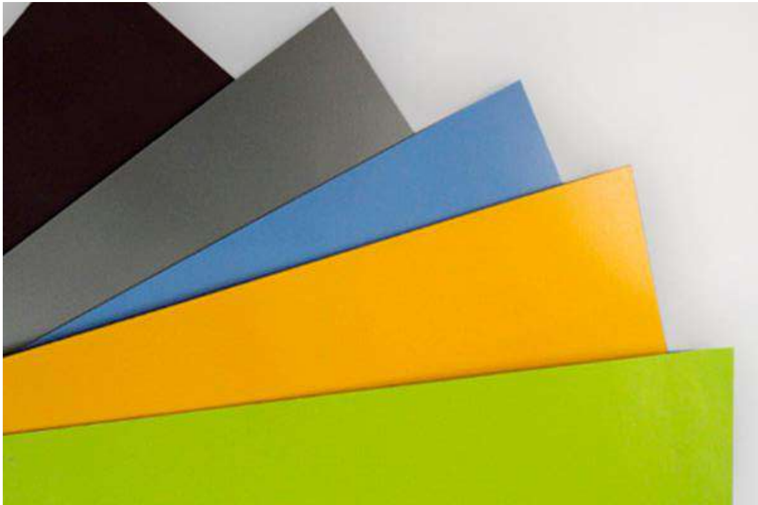
Figura 72: Laminado de PET reciclado
