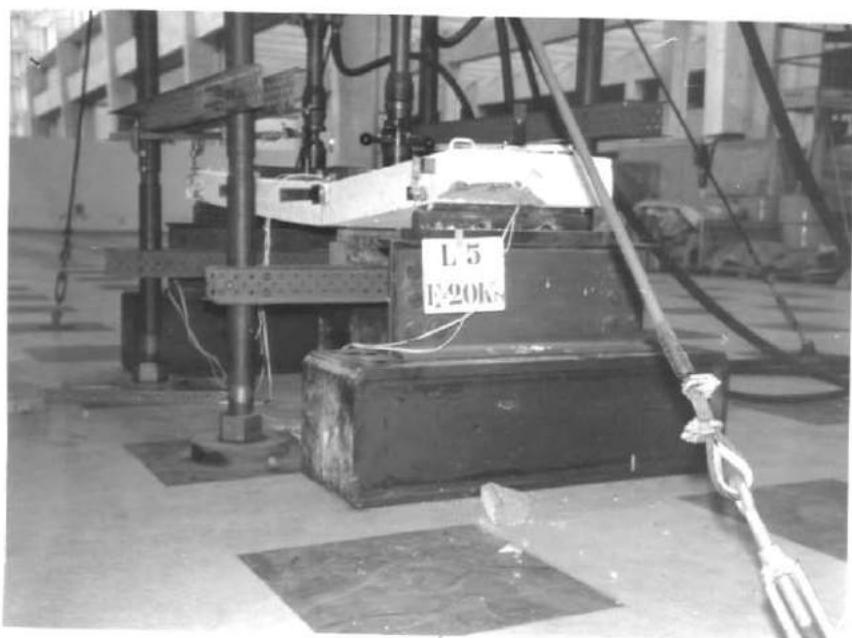
Fig. 74 - Ruptura da laje L5
