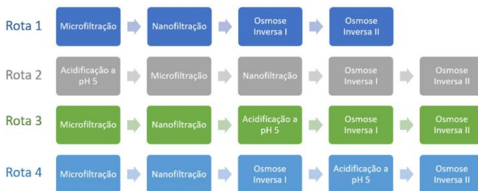
Figura 21 - Rotas aplicadas no tratamento de lixiviado na primeira etapa. Fonte: Hupsel, 2021
