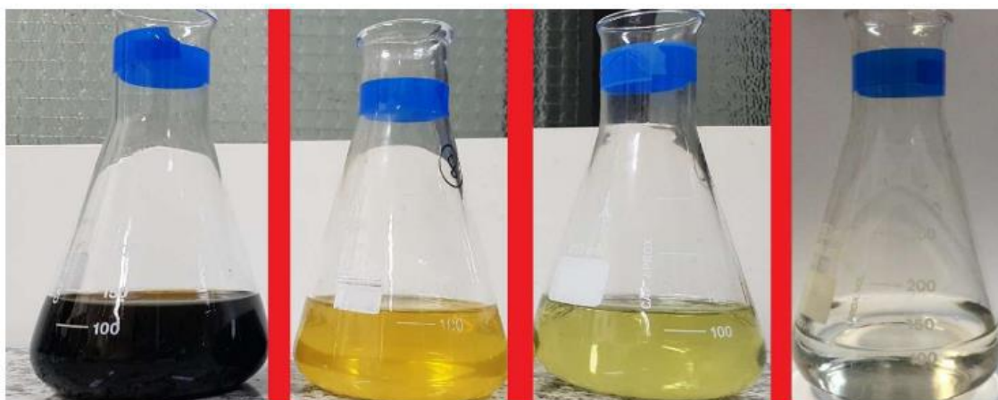
Figura 29 - Remoção de cor e turbidez após cada etapa de tratamento. Sendo a primeira imagem referente ao lixiviado bruto, a segunda após a etapa de ozonização, a terceira após a etapa de microfiltração e a última após a OI e tratamento total. Fonte: Marques, 202
