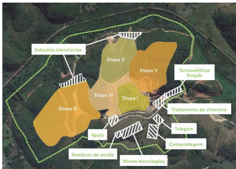
Figura 8 - Mapa com a localização das etapas de implantação do CTDR-BR. Fonte: INEA, 2017
