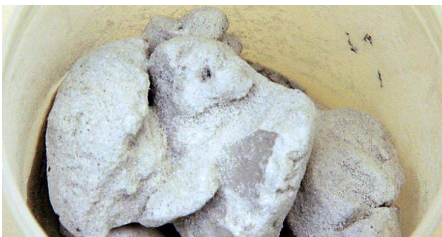
Figura 10 - Recuperação de fósforo no esgoto doméstico através da precipitação em forma de cristais de estruvita. Fonte: https://jornal.usp.br/ciencias/cientistas-e-engenheiros-trabalham-em-novas-solucoes-para-descontaminar-solos/ . Acesso em: 18 de set. 2021
