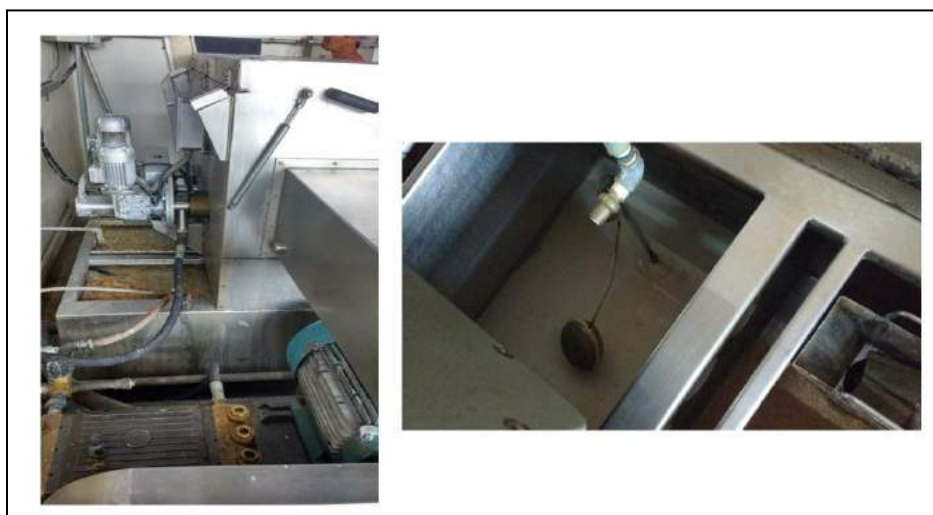
Figura 5.11: Máquina B operando com a boia em funcionamento, controlando a vazão de entrada e boia da máquina C (Fonte própria)
