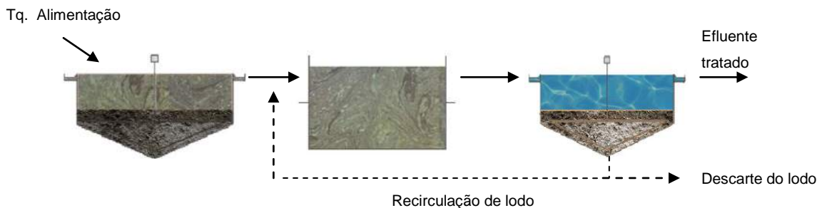
Figura 3.8: Representação esquemática de configuração de Lodos Ativados (Fonte: adaptado de DEZOTTI, 2011)
