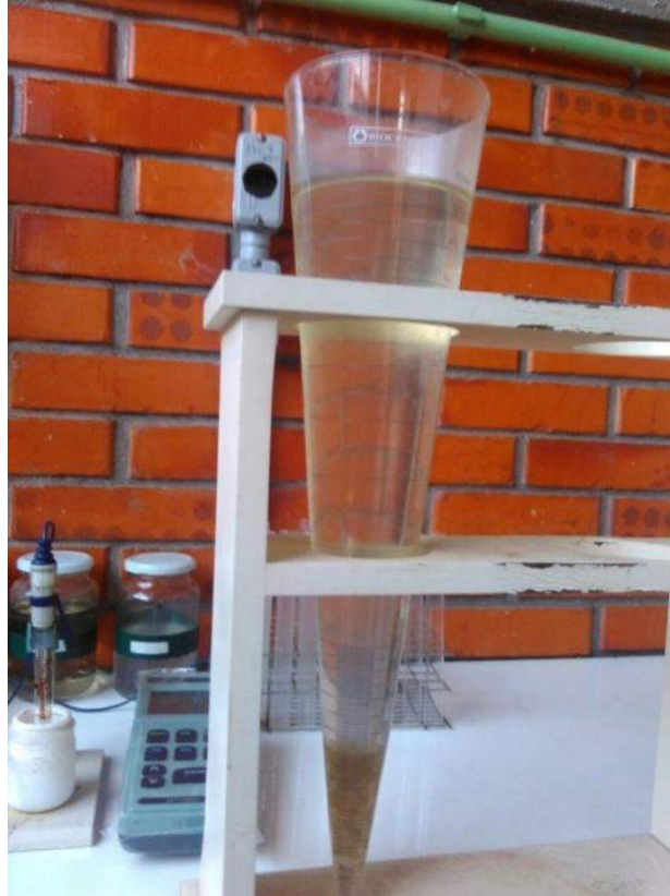
Figura 5.18: Análise de sólidos sedimentáveis da amostra de saída do decantador biológico antes da dosagem de nutrientes (Fonte Própria)
