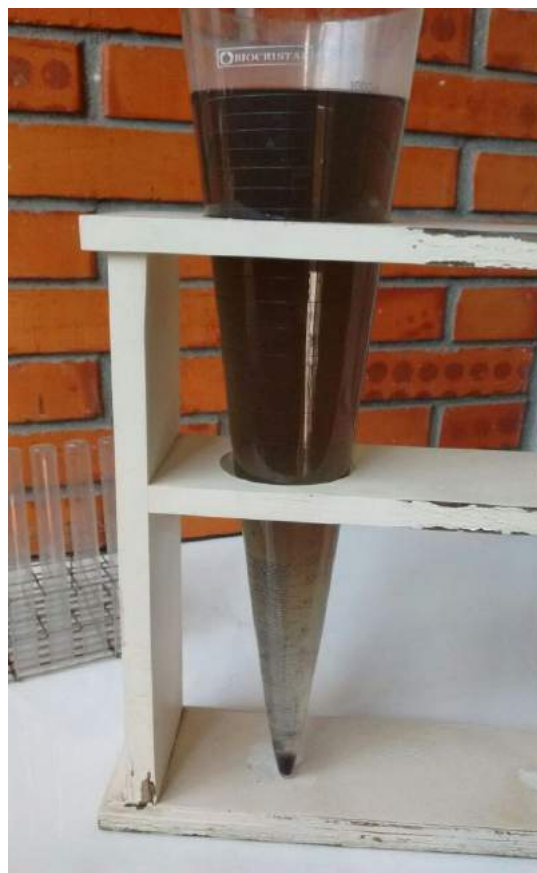
Figura 5.17: Alta concentração de sólidos sedimentáveis na entrada do Reator MBBR (Fonte própria)
