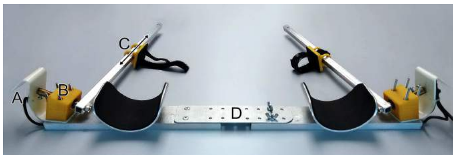
Figura 3.4: Goniômetro desenvolvido pelo Laboratório de Instrumentação Biomédica. (A) e (B) conectam o sensor as hastes móveis, (C) é o prendedor das hastes ao punho dos voluntários, e (D) modifica a largura do goniômetro.
