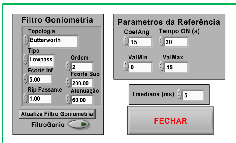
Figura 3.9: Tela aberta pelo botão FILTROS. CoefAng é o coeficiente angular da rampa de extensão e flexão, Time ON é o tempo total da referência, ValMin e ValMax configuram os valores mínimo e máximo da referência respectivamente. Tmediana(ms) é a janela de tempo da mediana móvel em milissegundos. Fcorte Inf e Sup são as frequências de corte inferior e superior respectivamente, em Hertz. Rip Passante é o ripple na banda passante, e Atenuação é a atenuação na banda de rejeição, ambos em dB.
