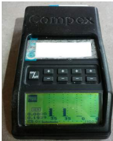
Figura 2.5: Aparelho comercial de estimulação elétrica funcional fabricado pela Compex (EUA). Retirado de [28].
