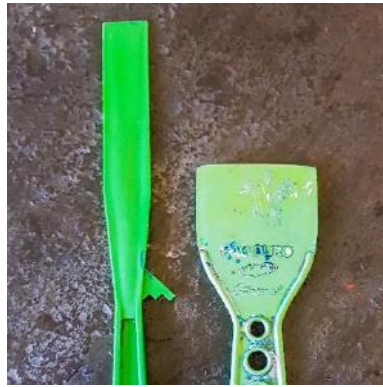
Figura 98 - Fotografia de tipos de espátulas usadas nos procedimentos da serigrafia. Atente que diferente das outras técnicas de gravura, essa espátula é de plástico, para que não venha a danificar a tela. Fonte: ALMEIDA, Fabiana Moreira de. 2019.
