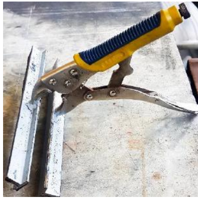
Figura 97 - Fotografia de uma garra, instrumento que auxilia na hora do esticar a tela no chassi. Fonte: ALMEIDA, Fabiana Moreira de. 2019.
