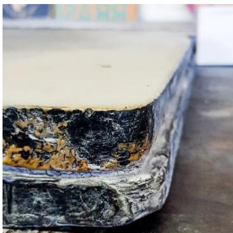
Figura 75 - Fotografia de duas pedras litográficas, que após muito sofrerem as corrosões decorrentes das lavagens as quais foram submetidas, precisaram ser encoladas.
