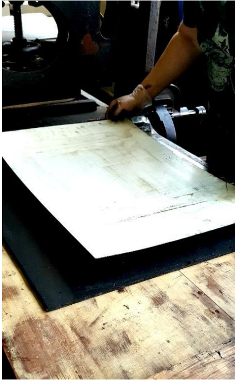
Figura 93 - Fotografia do momento em que se coloca o "sanduiche" de papel, papel jornal, mata-borrão e o tímpano. Fonte: ALMEIDA, Fabiana Moreira de. 2019.
