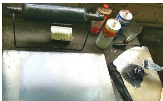
Figura 85 - Mesa de entintagem pronta para ser usada, com rolo de couro. Fonte: ALMEIDA, Fabiana Moreira de. 2019.
