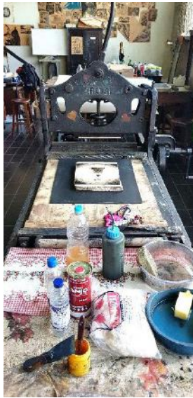
Figura 86 - Fotografia da organização da prensa antes de iniciar o processo de impressão. A pedra já posicionada, com a ratora estabelecida para o seu tamanho e as devidas marcações de início e final da pedra. Além de todos os materiais que serão necessários nesse processo. Fonte: ALMEIDA, Fabiana Moreira de. 2019.
