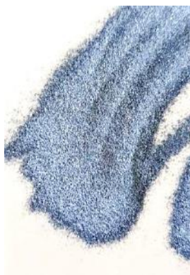
Figura 73 - Fotografia em detalhe do Pó de esmeril de gramatura 150. Fonte: ALMEIDA, Fabiana Moreira. 2019.
