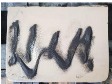
Figura 69 - Fotografia do passo 3: Usar Pó de Esmeril de gramatura 150 para iniciar o fechamento do poro da pedra. Fonte: ALMEIDA, Fabiana Moreira de. 2019.
