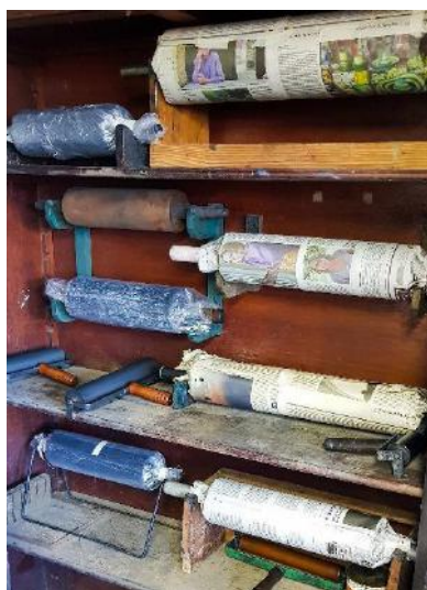
Figura 84 - Fotografia dos rolos usados em Litografia, onde na coluna da esquerda envoltos em plástico, temos repousando os rolos de couro. E na coluna da direita, embrulhados em jornal os rolos de borracha. Fonte: ALMEIDA, Fabiana Moreira de. 2019.
