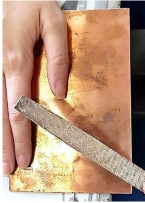
Figura 24- Fotografia do momento em que se lima a borda, para eliminação da rebarba. Fonte: ALMEIDA, Fabiana Moreira de. 2019.
