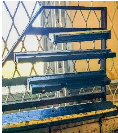
Figura 87 - Fotografia do dispenser das ratoras do ateliê de litografia da EBA/UFRJ. Lembrando que o tamanho da ratora deve ser proporcional ao da pedra, não pode sobrar ou faltar muito, pois é prejudicial tanto para a pedra quanto para a impressão. Fonte: ALMEIDA, Fabiana Moreira de. 2019.
