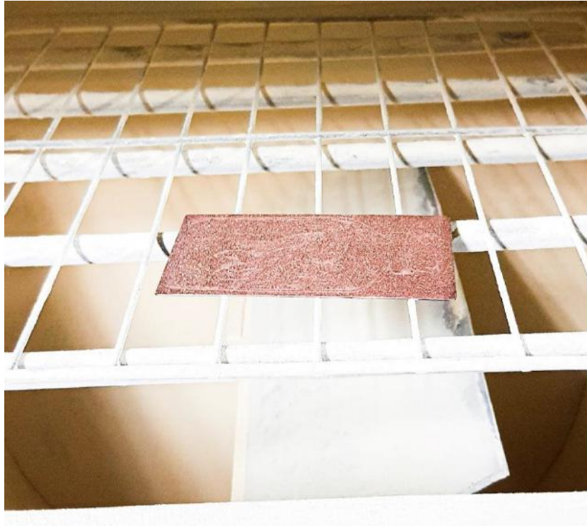
Figura 42- Placa de cobre na caixa de breu, recebendo a cobertura dos grãos. Essa é uma caixa projetada para que o pó de breu cubra a placa de maneira uniforme. O gravador opta pela gramatura desse grão e em alguns casos pode realizar aplicações mais ou menos concentradas em algumas áreas. Fonte: ALMEIDA, Fabiana Moreira de. 2019
