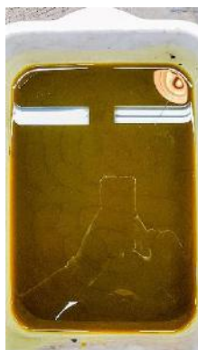
Figura 35 - Fotografia da bacia com Percloroeto de ferro a 25°B. Fonte: ALMEIDA, Fabiana Moreira de. 2019.
