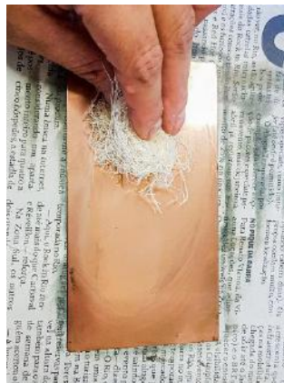
Figura 28- Fotografia do ato de polimento com o auxílio de uma estopa. Este procedimento deve ser repetido o quanto necessário for. Fonte: ALMEIDA, Fabiana Moreira de. 2019.
