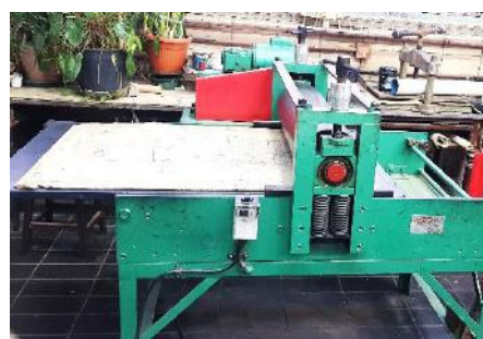
Figura 12- Fotografia de uma prensa elétrica, que serve tanto para xilogravura, linógravura e gravura em metal. Fonte: ALMEIDA, Fabiana Moreira de. 2019.
