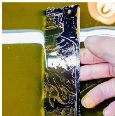
Figura 36 - Fotografia da placa de cobre sendo retirada do banho de mordeduro, passados 30 minutos. Fonte: ALMEIDA, Fabiana Moreira de. 2019.
