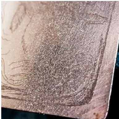
Figura 43- Fotografia em detalhe da disposição do pó de breu sobre a placa. Fonte: ALMEIDA, Fabiana Moreira de. 2019
