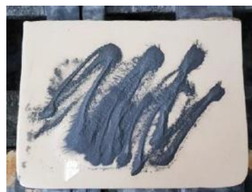
Figura 71 - Fotografia do passo 5: Último pó de esmeril a 220. Faz-se o uso desse pó até que a pedra fica homogênea, ou seja, sem riscos e com os poros por iguais. Fonte: ALMEIDA, Fabiana Moreira de. 2019.
