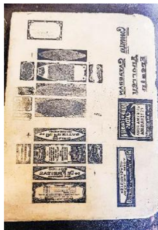
Figura 63 - Fotografia de matriz litográfica de mais de uma embalagem. Fonte: ALMEIDA, Fabiana Moreira de. 2019.
