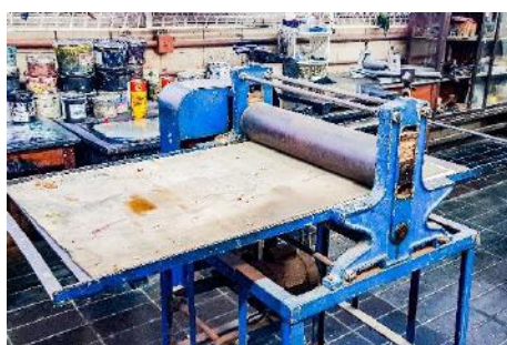
Figura 11- Fotografia de uma prensa Calcográfica elétrica. Fonte: ALMEIDA, Fabiana Moreira de. 2019.
