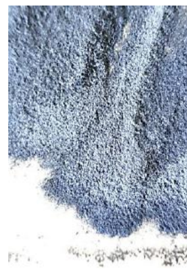
Figura 74 - Fotografia em detalhe do Pó de esmeril de gramatura 220. Fonte: ALMEIDA, Fabiana Moreira. 2019.
