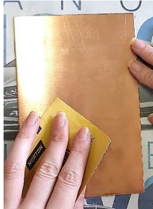
Figura 25- Fotografia do momento em que se lixa toda a placa. Nessa imagem já está na numeração mais fina. Fonte: ALMEIDA, Fabiana Moreira de. 2019.
