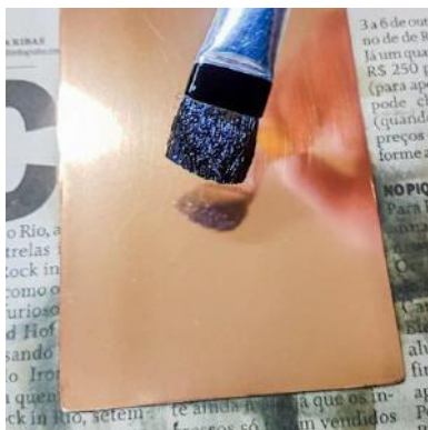
Figura 30- Fotografia da aplicação do verniz com um pincel de cerdas macias e a placa limpa e sem impurezas deve-se aplica-lo de maneira a não deixa a película nem muito grossa e nem muito fina. Fonte: ALMEIDA, Fabiana Moreira de. 2019.
