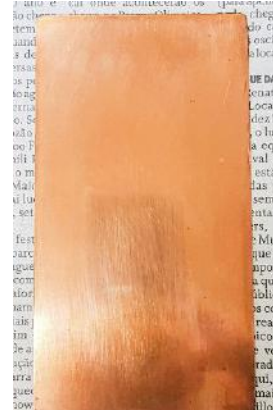
Figura 26- Fotografia da placa lixada. O resultado é uma cobertura fosca, mas homogênea. Fonte: ALMEIDA, Fabiana Moreira de. 2019.
