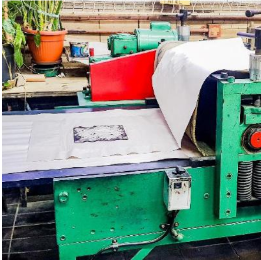
Figura 59 – Fotografia da organização da prensa na hora da impressão. A mancha de preto seria onde a placa ficaria repousada. A prensa desta foto é uma elétrica moderna. Que serve tanto para impressão de xilogravura, quanto a gravura em metal. Fonte: ALMEIDA, Fabiana Moreira de. 2019.
