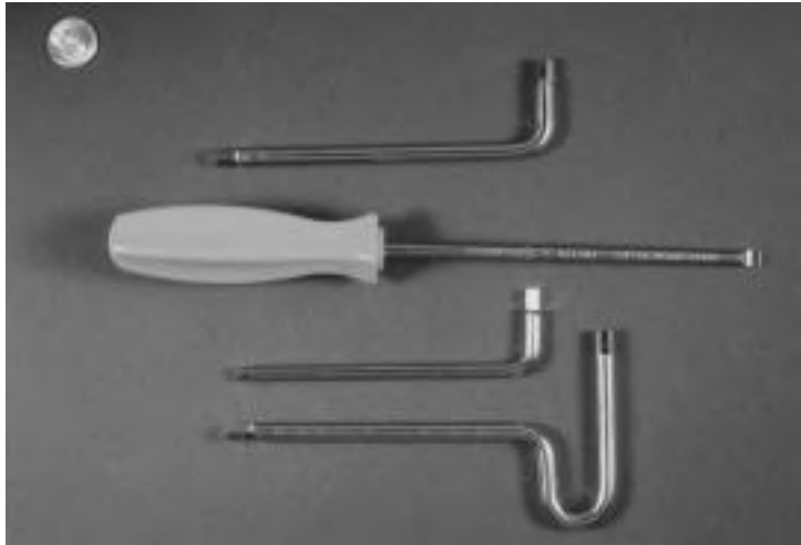
Figura 31: Ferramentas SteriTools, confeccionadas em aço inoxidável endurecido por precipitação 465 da Carpenter Technology. Fonte: Hand tools for service in corrosive environments, Anti-Corrosion Methods and Materials, Vol.48 No.5. 2001.
