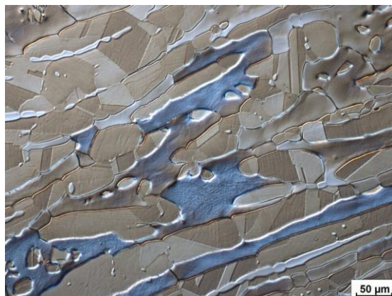
Figura 10: Aço inoxidável duplex apresentando ferrita em azul e austenita em marrom claro à marrom escuro. Decapagem eletrolítica dupla; inicialmente em ácido oxálico 10%, em água, seguida de decapagem em hidróxido de sódio 20%, em água. DIC. Fonte: Struers. Disponível em https://www.struers.com/en/Knowledge/Materials/Stainless-Steel#structure - THE MAIN CHARACTERISTICS OF STAINLESS STEEL.
