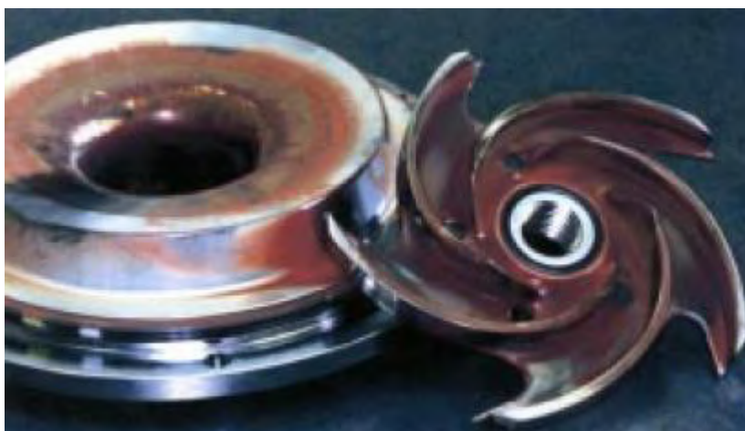
Figura 32: Aparecimento de Rouging em impelidor de bomba centrífuga feita em aço inoxidável. Fonte: FAWLER, M. - Grupo Humma)
