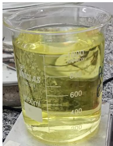
Figura 27: Ensaio de perda de massa após 20h - Ácido Cítrico
