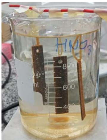
Figura 26: Ensaio de perda de massa após 20h - Ácido Nítrico
