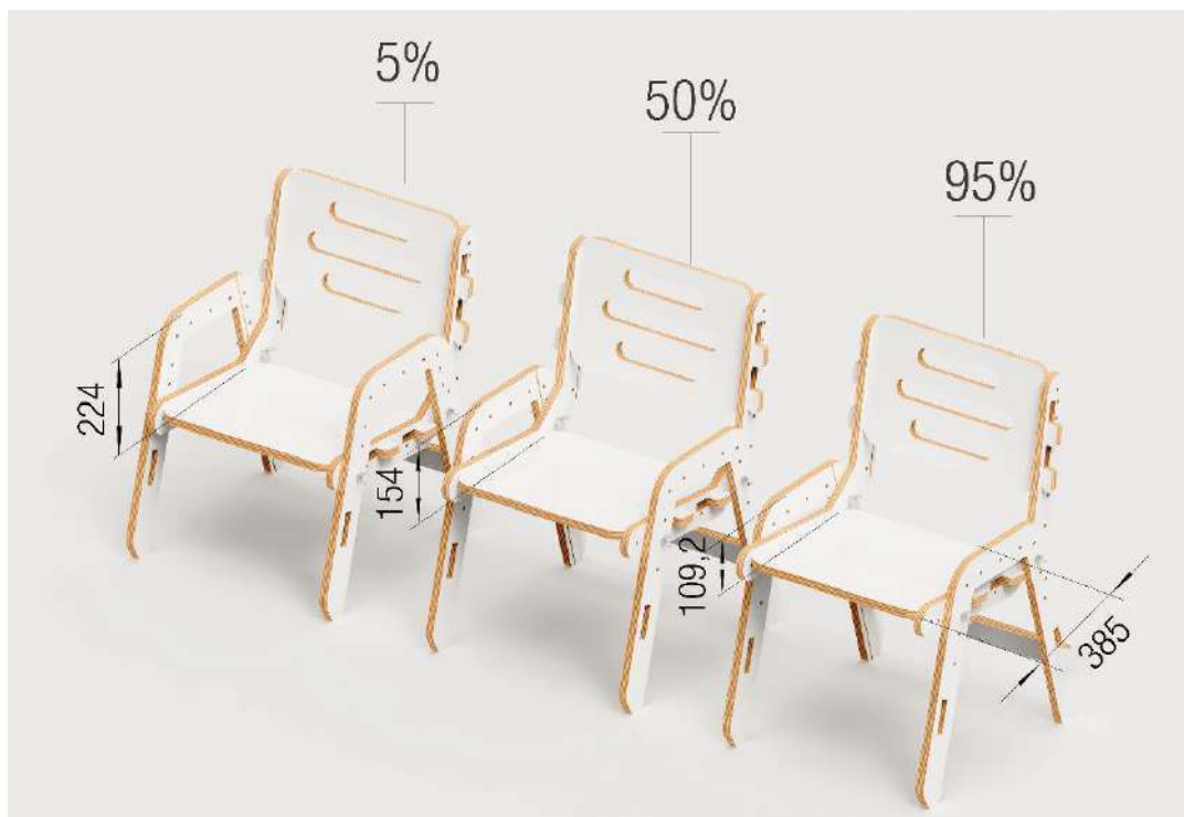
Figura 105: Dimensões da altura da superfície inferior do assento ao topo do módulo 1 (medidas em mm)
