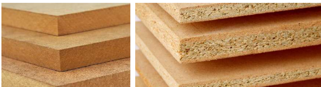
Figura 33 : à esquerda, chapas de MDF. À direita , chapas de MDP
