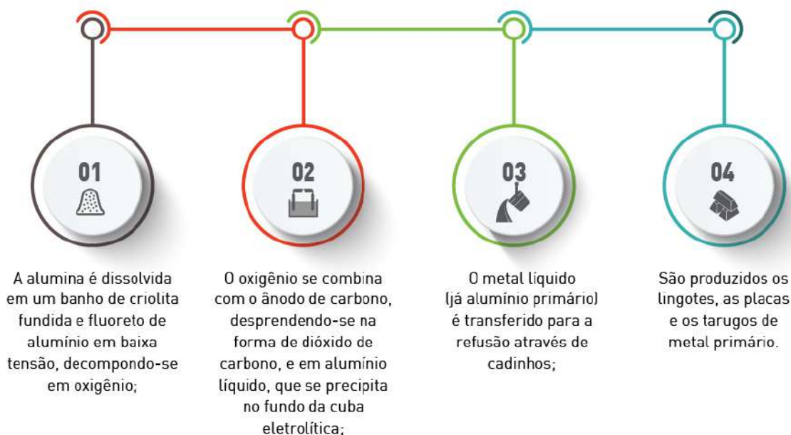
Imagem 101 - Processo de redução do alumínio.
