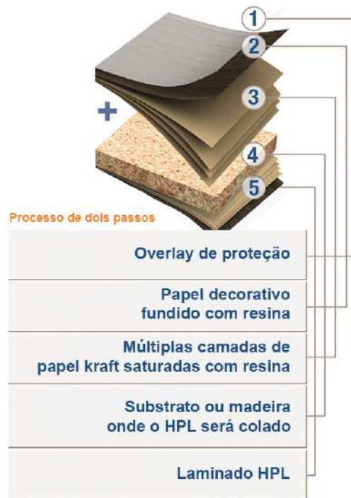
Imagem 110 - Processo de revestimento com HPL.
