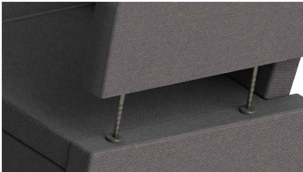
Fig. 57 – Conexão entre braço removível e buchas da parte lateral da poltrona. (Fonte: Autor, 2021)
