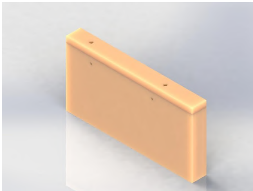
Fig. 50 – Suportes laterais revestido de espuma de poliuretano. (Fonte: Autor, 2021).
