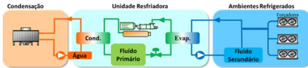
Figura 23 – Sistema indireto de refrigeração
