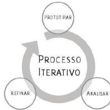
Figura 1 - Processo iterativo de Design proposto por Zimmermam (Apud Credidio,2007) Fonte < https://repositorio.ufpe.br/bitstream/123456789/3415/1/arquivo4382_1.pdf >
