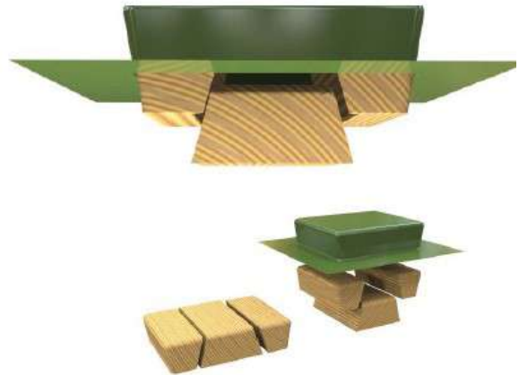
Figura 71 - Exemplo do método corte no molde. Fonte: < https://formech.com/wp-content/uploads/Vacuum Forming Guide.pdf >
