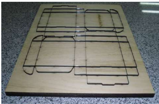
Figura 59- Estrutura com faca de corte montada
