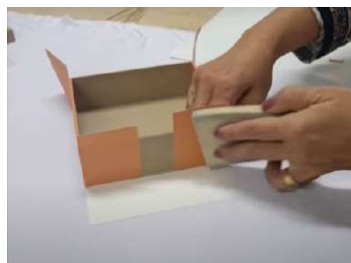
Figura 65 - Processo manual de envelopagem. Fonte: < https://www.youtube.com/watch?v=fe955CuYW5Y >
