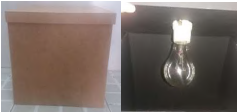
Figura 12 - Caixa de MDF 30x30x30cm e caixa com a pintura na cor preta e instalação de bocal para lâmpadas.
