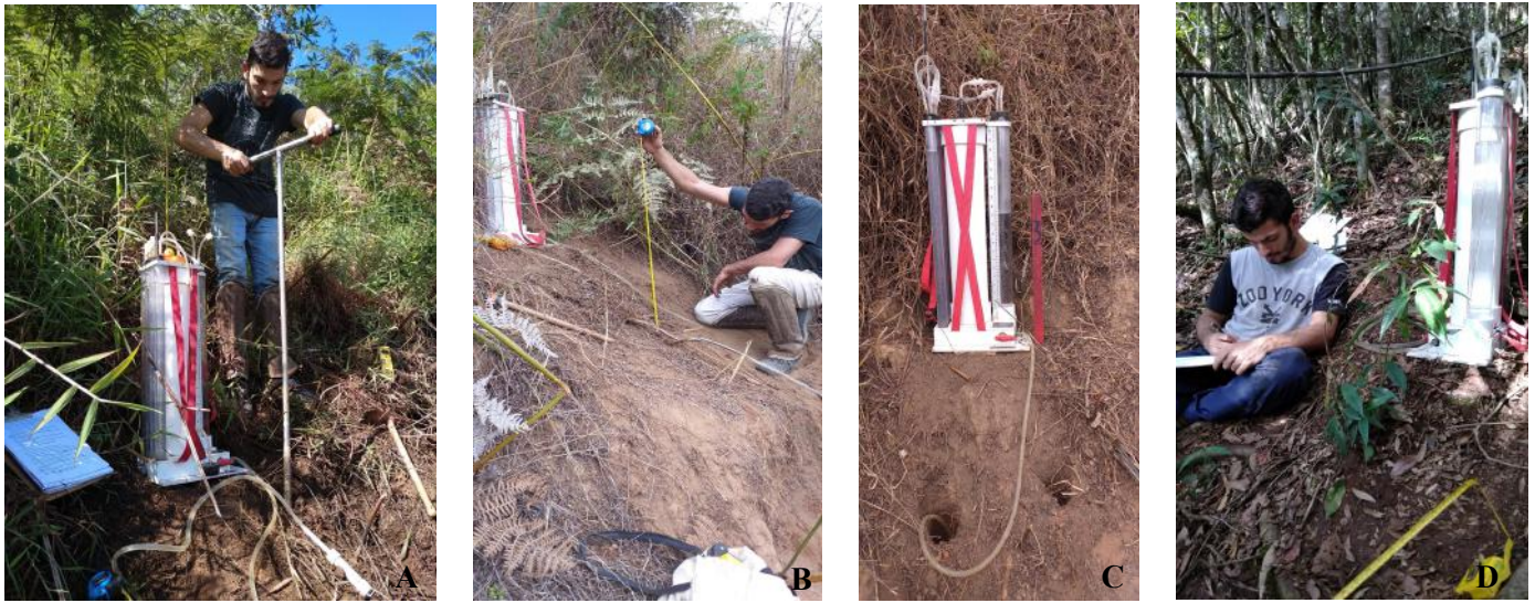
Figura 9: Preparação dos pontos de ensaio para determinação da K_{sat} a) abertura do furo com auxílio do trado manual; b) medida da profundidade do furo; c) posicionamento do equipamento nivelado para início dos ensaios; d) execução dos ensaios.
