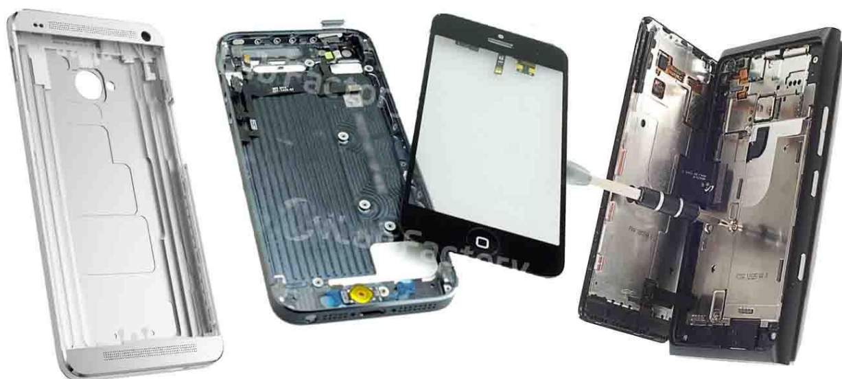
Figura 22 - Unibodies de Alumínio do HTC One e Iphone 5 e de policarbonato do Lumia 900 - Fonte: HTC, Nokia, iLab Factory
