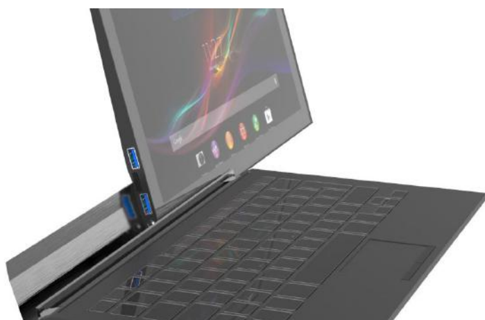
Figura 77 - Detalhe do Encaixe Lateral do Periférico Tablet no Periférico Teclado. Fonte: Acervo dos Autores.
