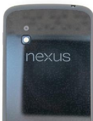
Figura 21 - Nexus 4. Parte de trás de Gorila Glass. - Fonte: Anandtech
