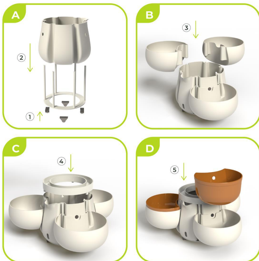
Figura 129: Passo a passo da montagem do módulo. Fonte: Elaborado pela autora.
