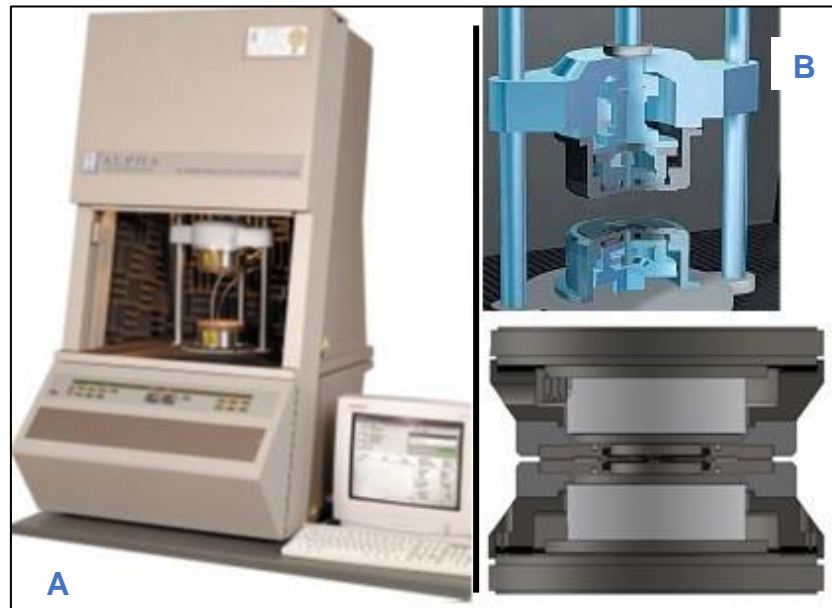
Figura 7: A) Analisador de processamento de borracha – RPA (Rubber Process Analyzer) e B) representação da câmara interna de análise. Fonte: Adaptado de Alpha Technologies.
