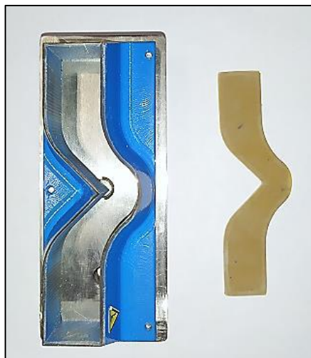
Figura 13: Cunho e corpo de prova (tipo C) de rasgamento – ASTM D624.
