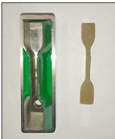
Figura 14: Cunho e corpo de prova de tração – DIN 53504.
