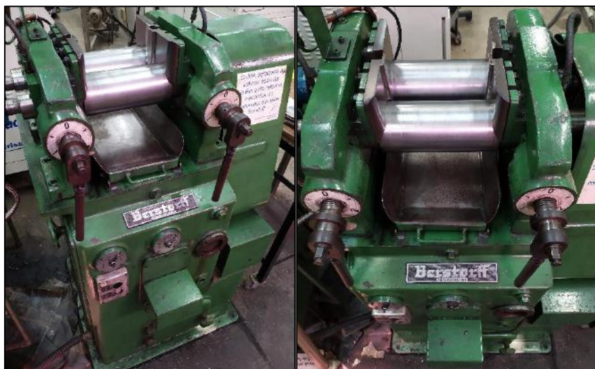
Figura 6: Misturador aberto de cilindros Berstoff, utilizado no processamento das composições elastoméricas.
