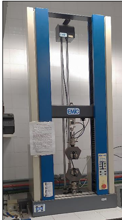
Figura 12: Máquina Universal de Ensaio – EMIC DL3000.
