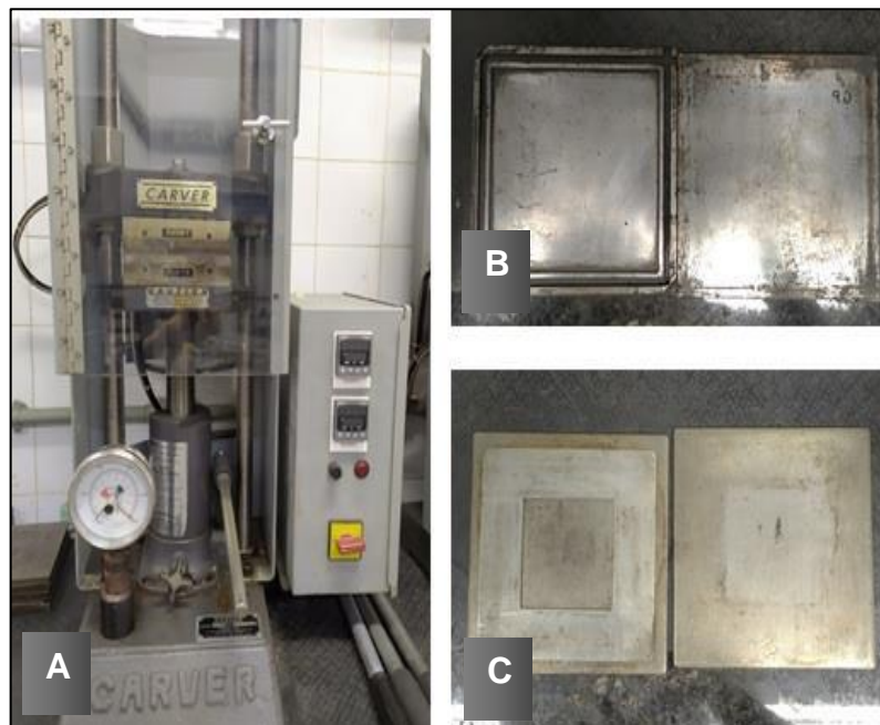
Figura 10: A) Prensa Hidráulica Carver com aquecimento elétrico; B e C) Moldes utilizados para vulcanização de placas elastoméricas a partir das quais serão cortados corpos de prova para ensaios mecânicos padrão ASTM e DIN, respectivamente resistência a rasgamento e resistência a tração.
