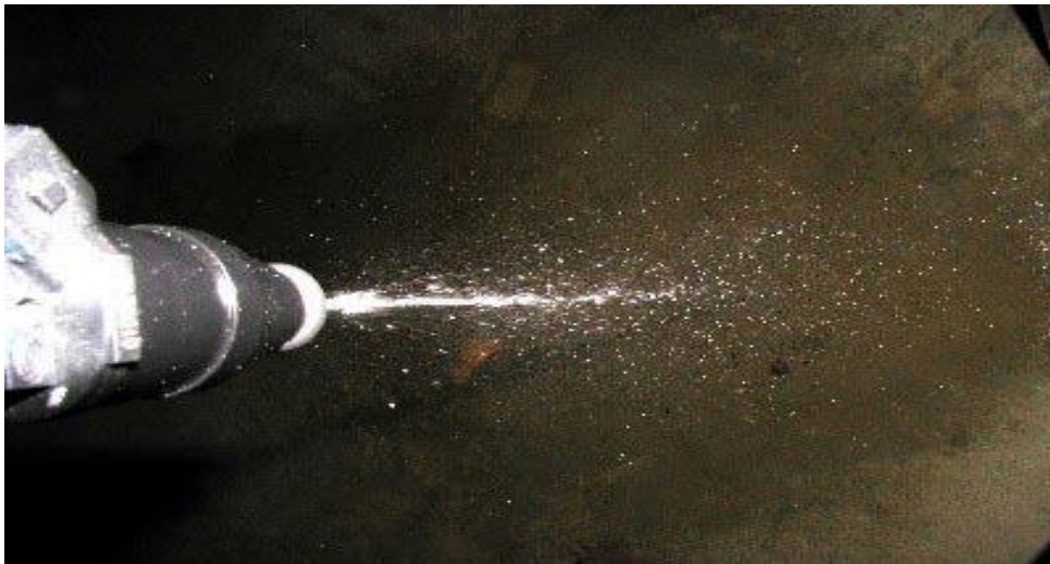
Figura 7: Injeção do spray de combustível na câmara de injeção
