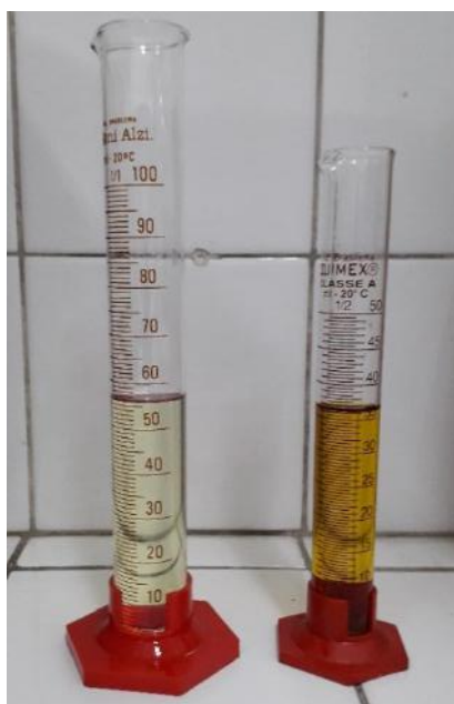
Figura 8: Preparo das blendas utilizando provetas graduadas
