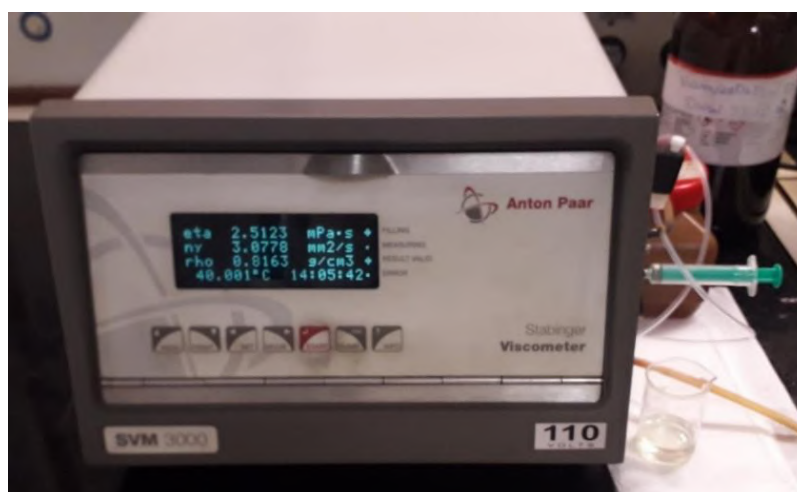
Figura 10: Análise de massa específica a 40°C e viscosidade cinemática a 40°C
