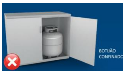
Figura 2.15: Botijão confinado, armazenamento incorreto
