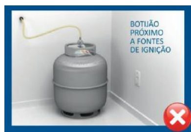
Figura 2.16: Botijão próximo de fonte de ignição, armazenamento incorreto.
