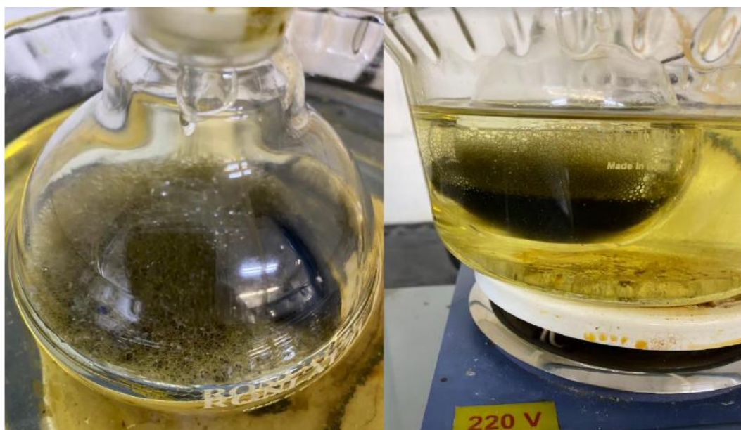
Figura 41. Geração de sabão no meio reacional
