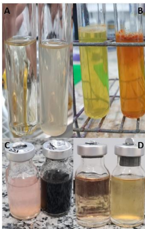
Figura 21: Ilustração dos tubos/frascos contendo meios estéreis (à esquerda), e o aspecto do meio de cultura face o crescimento de cada população bacteriana (à direita). População bacteriana e meio de cultura específico: (A) BHA/Meio Caldo Nutriente; (B) BPF/Meio Citrato Férrico Amoniacal; (C) BRS/Meio Postgate Modificado E); (D) BHAn/Meio Fluido Tioglicolato de Sódio.
