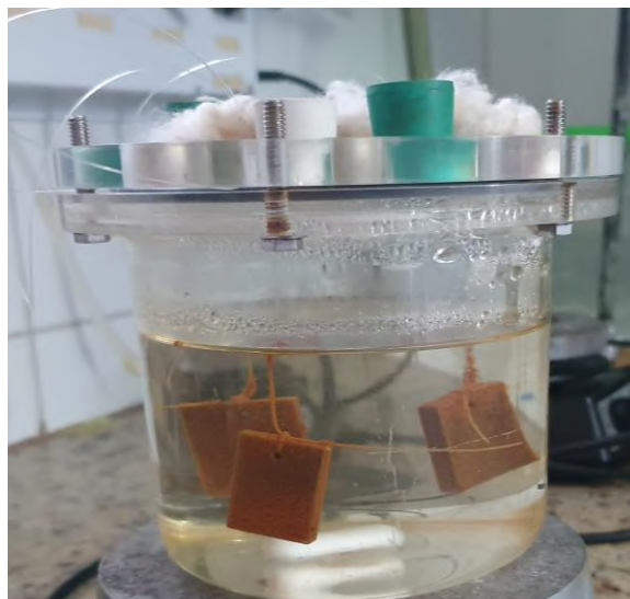
Figura 17: Esquema da etapa 1 contendo corpos de prova, 600 mL de APS e consórcios microbianos de BHA, BRS e BPF.
