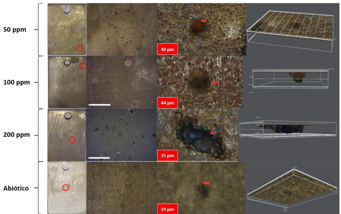
Figura 29: Análise da profundidade de pites nos cupons imersos em sistema abiótico e bióticos com adição do biocida THPS.
