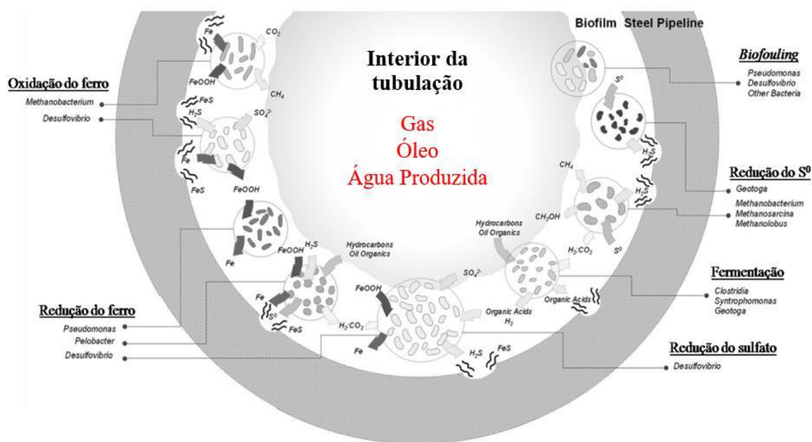
Figura 7: Interior de uma tubulação com demonstração de interação entre diferentes grupos microbianos e a superfície metálica. Adaptação de VIGNERON et al. , 2016.
