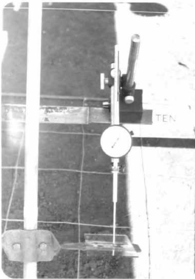
Fig.III.19 - Detalhe de um dos extensômetros
