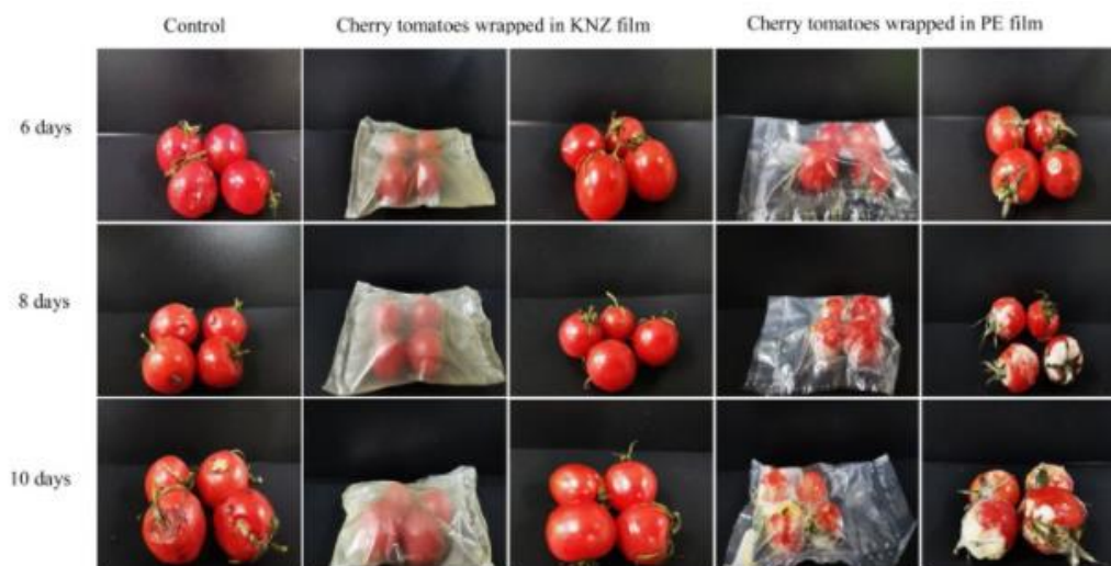
Figura 19: A qualidade visual com armazenamento do 6º ao 10º dia de tomate cereja sem embalagem, embalados com filme de konjac glucomanano/nanocelulose e embalados com filmes tradicionais de polietileno.
