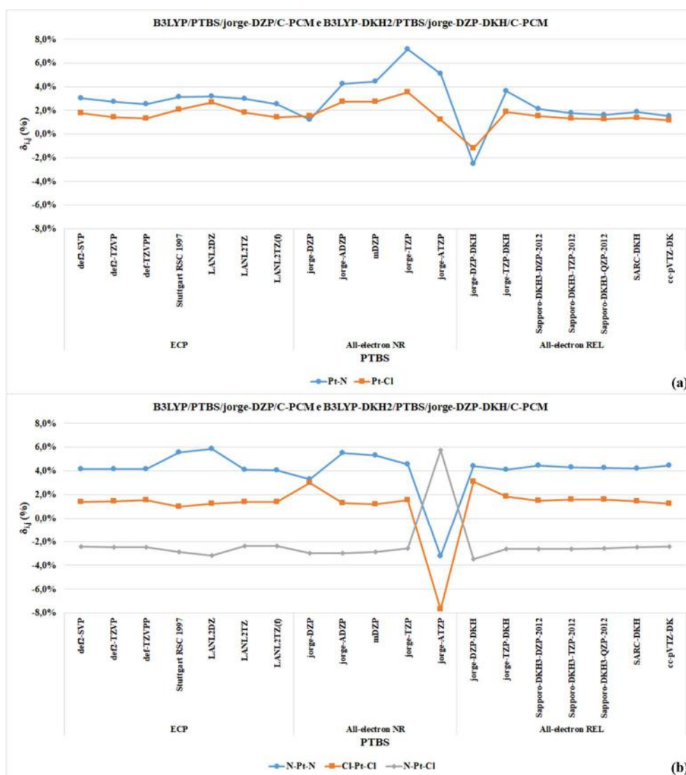
Figura 5 – Desvios relativos ( \delta_{ij} , %) calculados nos níveis B3LYP/PTBS/jorge-DZP/C-PCM e B3LYP-DKH2/PTBS/jorge-DZP-DKH/C-PCM para os parâmetros estruturais da cisplatina. (a) Distâncias de ligação Pt-N e Pt-Cl e (b) Ângulos de ligação N-Pt-N, Cl-Pt-Cl e N-Pt-Cl
