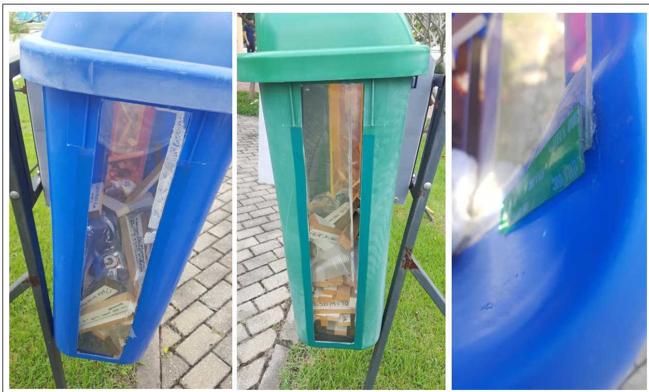
Figura 26: Desprendimento da placa de polipropileno da lateral da lixeira (esquerda e centro). A junção das duas partes é feita por fita adesiva (direita). Fonte: Acervo Pessoal
