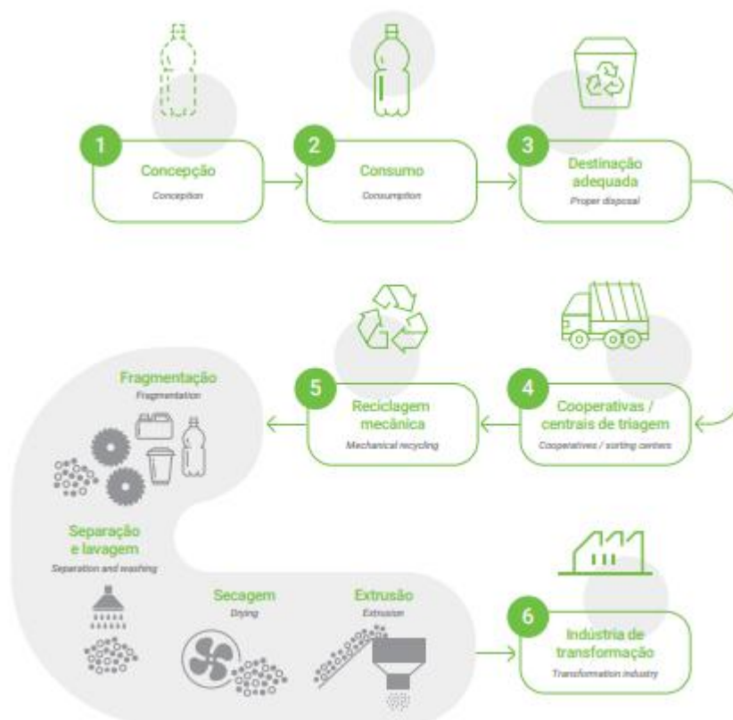
Figura 11 - Fluxo de reciclagem mecânica para resíduos plásticos
