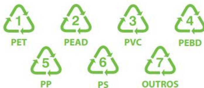
Figura 12 - Classificação de plásticos segundo a NBR 13230/2008
